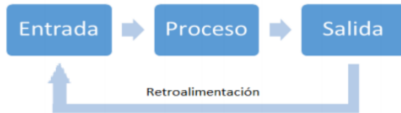
Figura 1.1 Esquema simple de retroalimentación.
