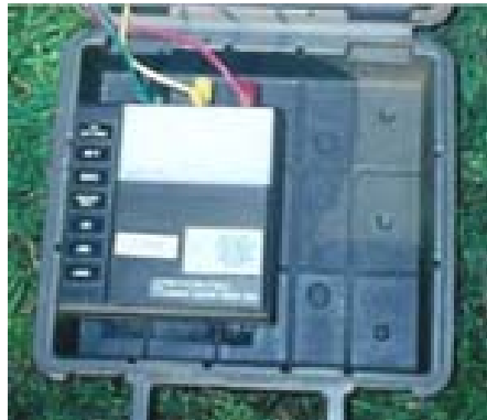
FIGURA 85. MEGGER DE TIERRAS
