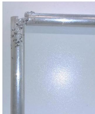
Figura 59. Cordón de soldadura 70[A]
