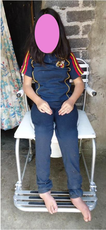
Figura 91. El dispositivo soporta la carga del usuario principal.
