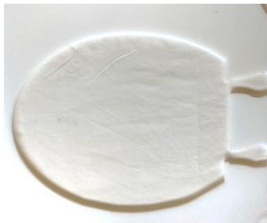
Figura 75. Placa de HDPE superior
