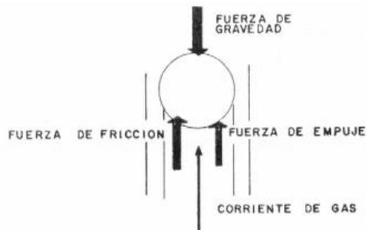
*Ilustración 13.- Fuerzas que actúan sobre una gota de líquido que cae contra una corriente de gas.<sup>[1]</sup>*
