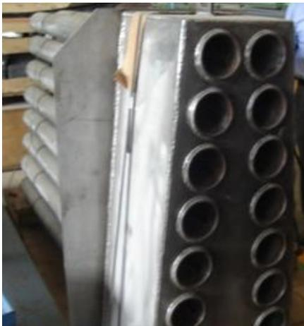
*Ilustración 20.- Internos tipo ciclónicos. <sup>[4]</sup>*
