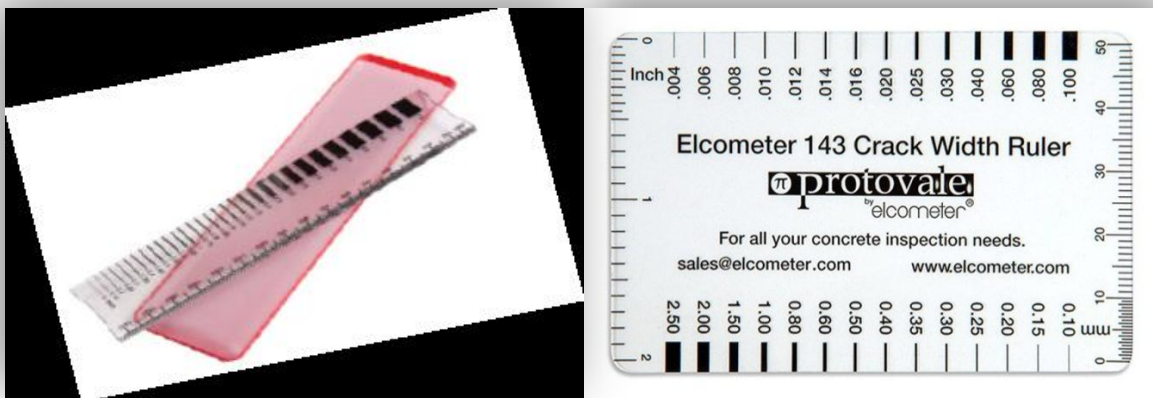
Fig. 1.1.a) Grietómetros de comparación
