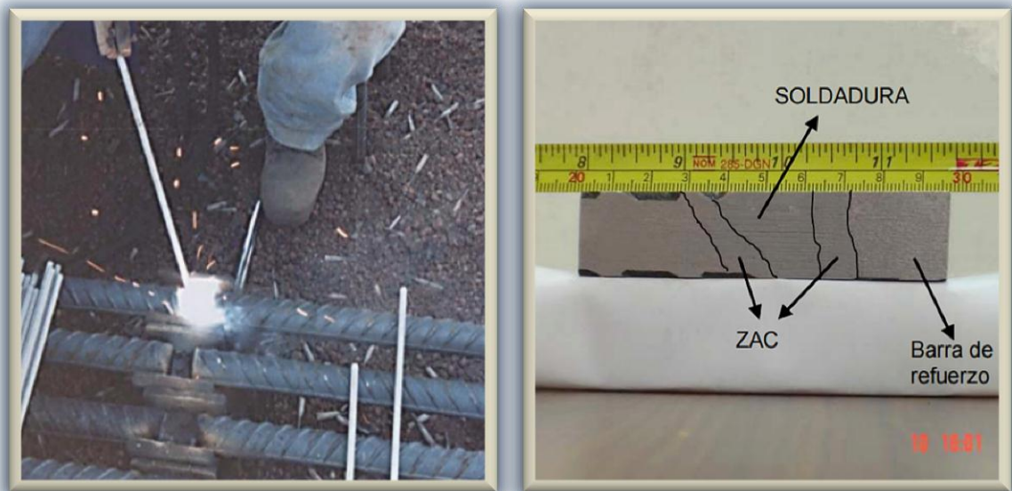
Fig. 2.2.4.1. Izquierda, imagen típica de soldadura de arco eléctrico para unión a tope de varillas corrugadas. Derecha, tramo de barra ensayado después de haberse soldado y en el cual se aprecia la zona de afectación por calor (ZAC), que a su vez derivó en una falla de tipo frágil
