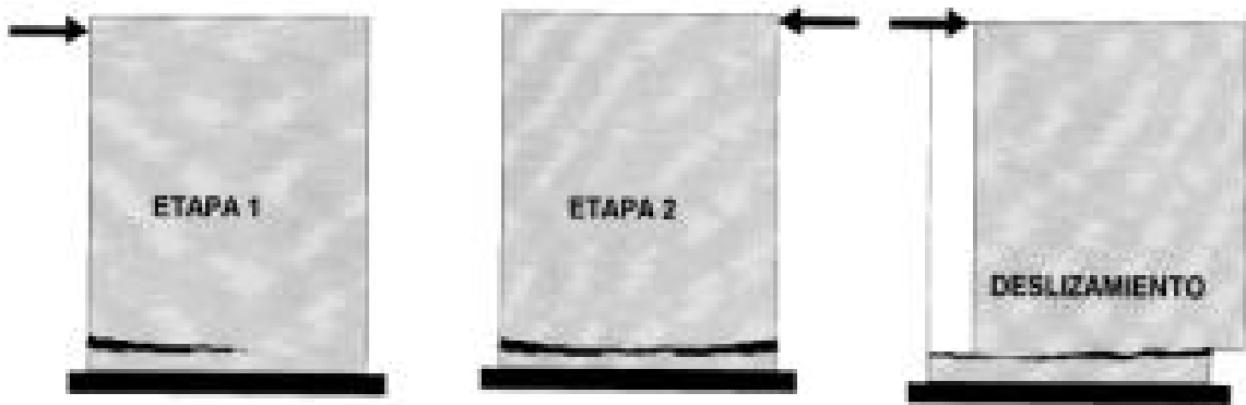
Transformación de la falla por flexión en falla por deslizamiento
