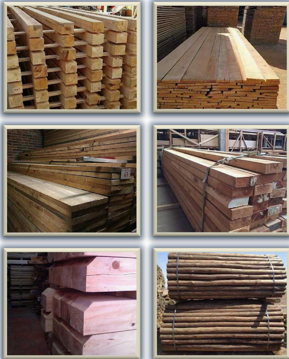
Fig. 2.1.2.5 Polines y tablas (arriba), tablones y vigas (en medio), bases y postes (abajo)
