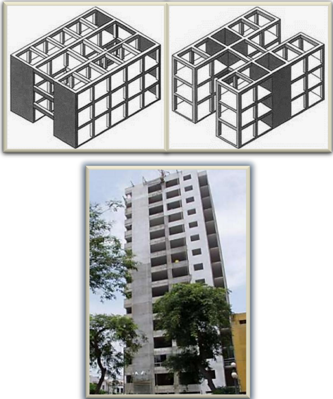
Fig. 2.5.1.3. Esquematización e imagen de estructuración con muros de rigidez. Arriba, configuración perimetral e interior (núcleo). Abajo, edificio esbelto con muros de rigidez perimetrales
