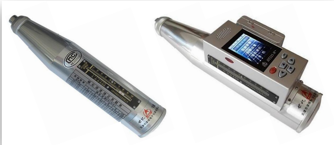
Fig. 1.3.2.8. Versiones actuales de Martillos Schmidt. Izquierda, modelo analógico con energía máxima de impacto de 0.225 kgf-m, y longitud de rebote de martillo hasta 75 mm. Derecha, modelo digital con prácticamente la misma capacidad y características de la versión analógica, pero equipado con pantalla LCD de alta resolución, memoria para 20 ensayos completos, interfaz de comunicación para exportación de datos, programa de análisis numérico y estadístico, etc.
