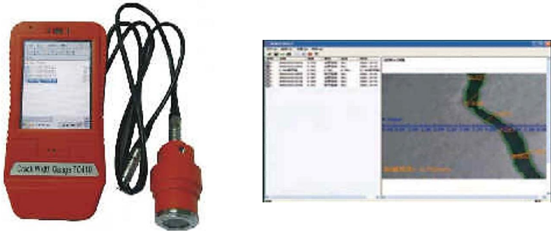
Fig. 1.1.b) Grietómetro digital con programa de análisis
