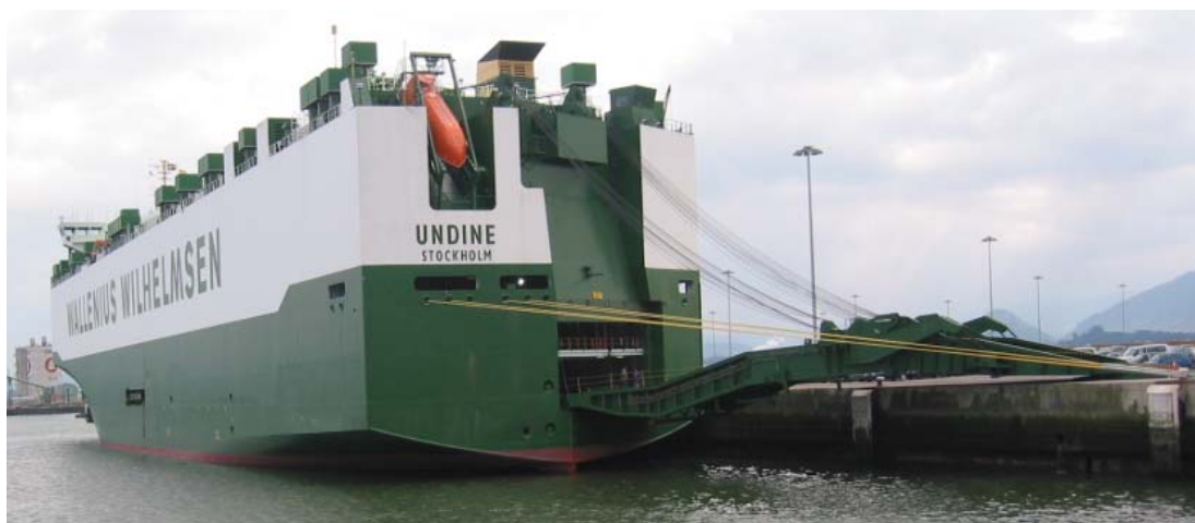
Figura 25: Ejemplo de un buque PCC con rampa en popa para carga y descarga de automóviles. Fuente www.wilhelmsen.com , junio 2008
