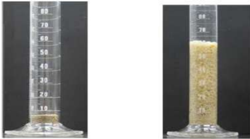
Fig. 2.1 Partículas de PPG antes (a) y después del hinchamiento (b).[22]
