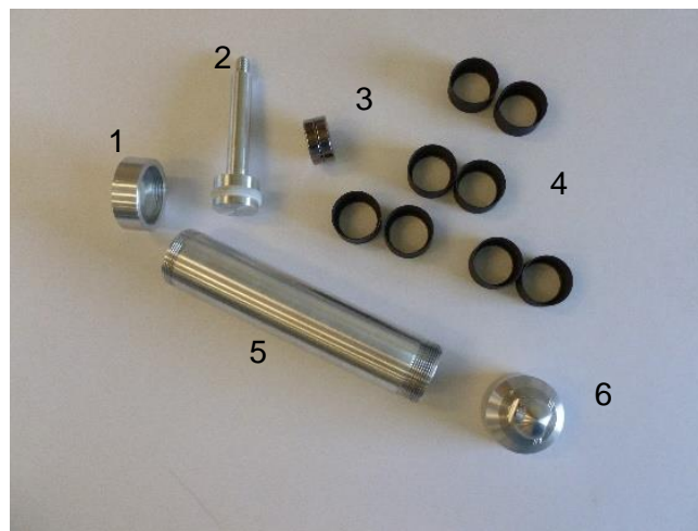
Figura 22. Foto de las piezas finales que conforman el sistema de suspensión magnética. 1) Tapa superior. 2) Émbolo. 3) Imanes permanentes. 4) Camisas de teflón. 5) Cilindro. 6) Tapa inferior.
