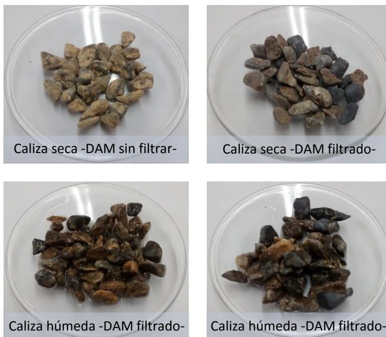
Figura 4-8 Caliza residual después de las pruebas de agitación
