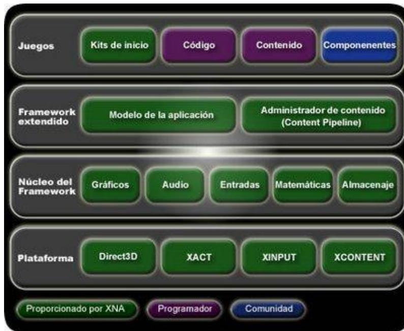
Figura 4.5 Arquitectura de XNA. Los recuadros verdes corresponden con la funcionalidad que ya viene incluida con el framework, los demás recuadros corresponden a elementos creados por los usuarios.<sup>[40]</sup>
