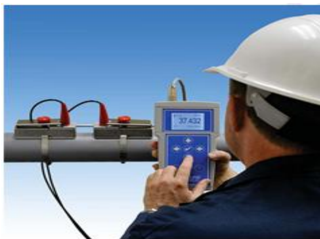
Fig. 3.2 Medidor de Flujo de Tiempo de Transito Portátil PTFM 1.0 para líquidos limpios con selección del Sensor para pequeños o grandes diámetros de tubería.
