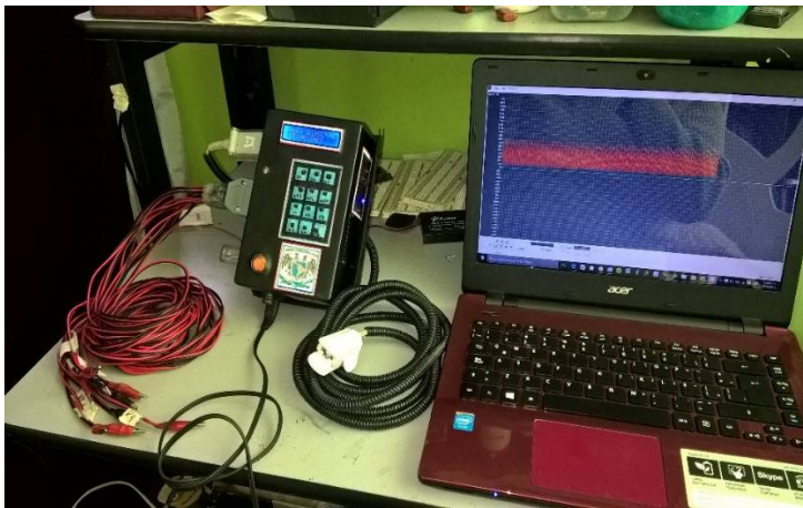
Figura 11.1.3 Electrocardiógrafo comunicado con computadora inalámbricamente.
