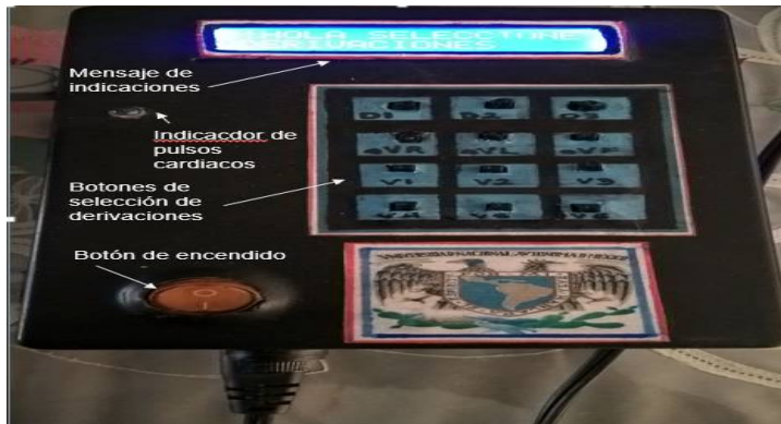
Figura 11.1.2 Funciones de pantalla, teclado, botón de encendido e indicador de pulsos cardiacos
