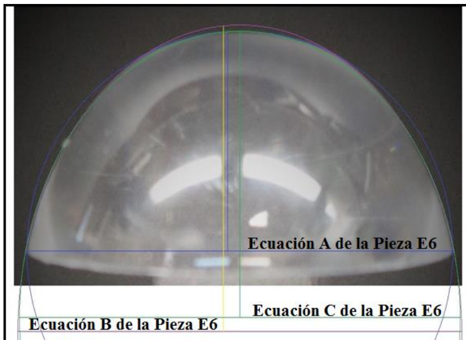
Figura 7.22 VARIANTES DE APROXIMACIÓN DE SUPERFICIE CON TRES ELIPSOIDES DIFERENTES DE LA PIEZA E6.
