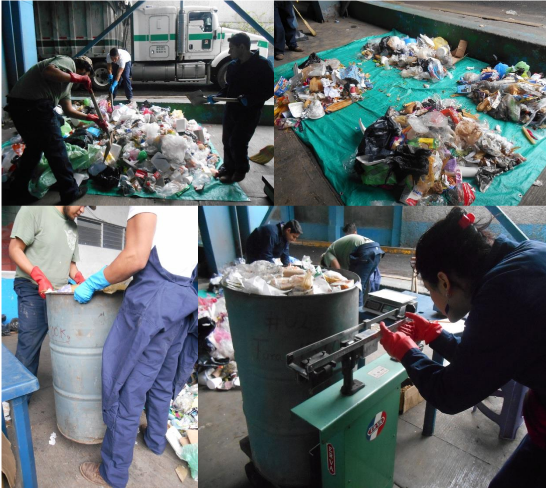
Figura 4.6 Mezcla, cuarteo y peso volumétrico 'in situ'
