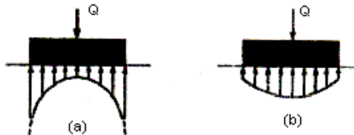
Figura 3.2. Presión de contacto en la base de una cimentación rígida en la superficie de una masa de suelo. (a) Material isotrópico elástico homogéneo, tal es el caso de una arcilla saturada.; (b) Material elástico homogéneo el cual aumenta su rigidez con el confinamiento, tal es el caso de una arena de poca cohesión u una grava.
