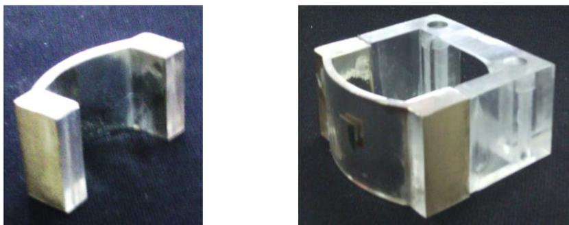
Fig. 3.10. Fabricación de uno de los espejo de la celda.
