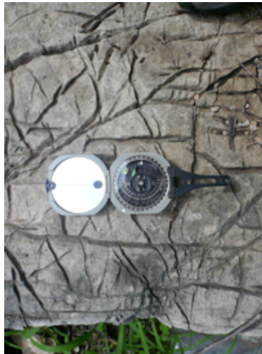
Fotografía 2. Las tres familias principales de fracturas en el afloramiento el Aguacero en la margen oriental del río. La alidada de la brújula señala la familia secundaria E-W.
