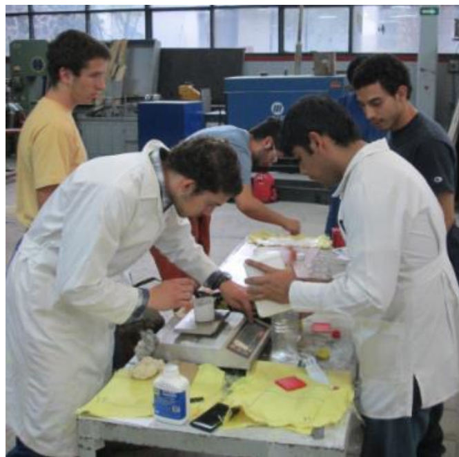
Figura 7.70 Equipo 2014 tomando medidas de resina para manufactura con fibra de aramida.
