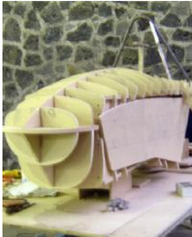
Figura 6.4. Estereotomía de la carrocería del coche tipo formula de la UNAM 2011.
