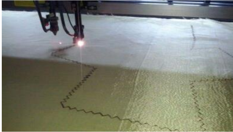
Figura 7.71 Corte laser de la fibra de aramida para la temporada 2014.
