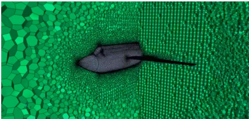
Figura 4.3 Mallado poliédrico de un avión y el volumen en estudio en interfaz de Star CCM+.
