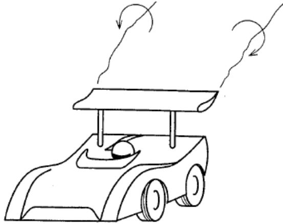
Figura 3.5 Vórtices en la estela causada por un alerón trasero de un coche de carreras [3].
