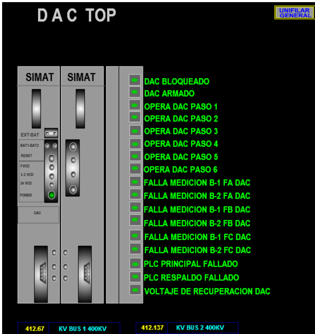
Figura 5.39. Esquemático del Disparo Automático de Carga (DAC)
