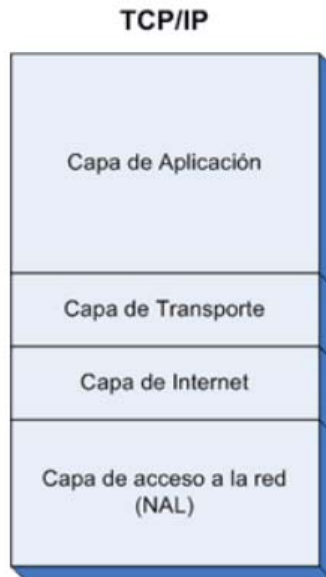
Figura 5.11. Descripción de las capas que contiene el protocolo Ethernet TCP/IP
