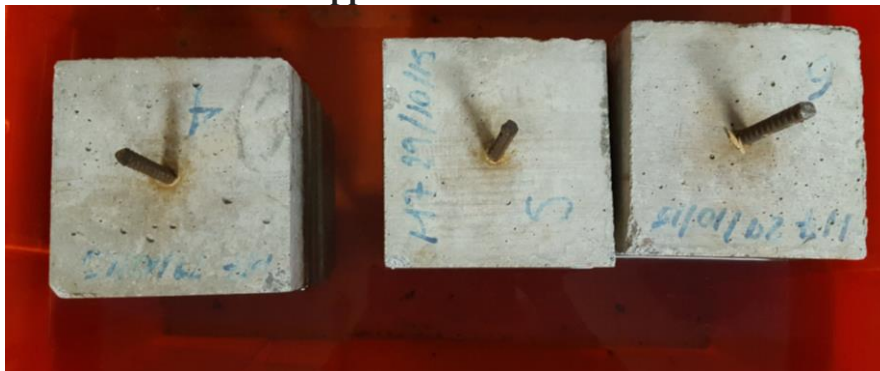
Imagen 6, especímenes del concreto M3C-1, sumergidas en la solución salina de 15000 ppm de iones Cl - .
