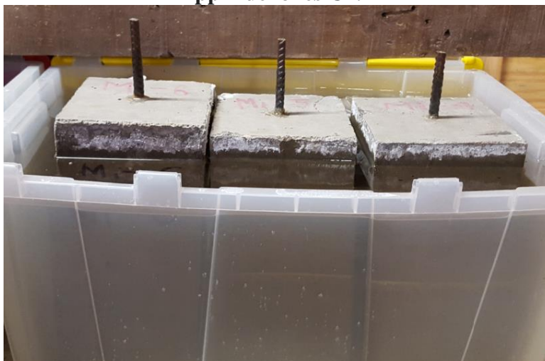
Imagen 2, especímenes del concreto MT2, sumergidas en la solución salina de 45000 ppm de iones \text{Cl}^- .
