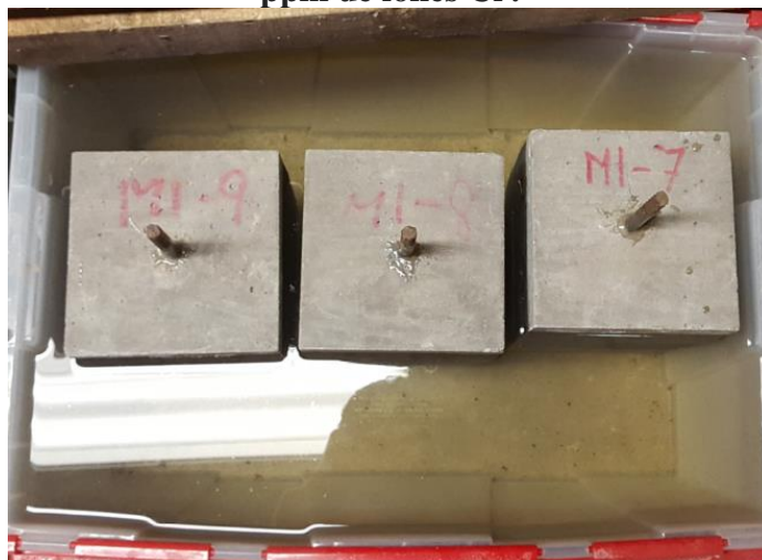
Imagen 1, especímenes del concreto MT1, sumergidas en la solución salina de 45000 ppm de iones \text{Cl}^- .
