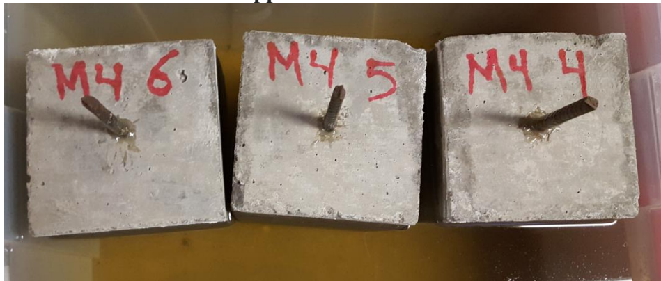
Imagen 4, especímenes del concreto MT4, sumergidas en la solución salina de 15000 ppm de iones Cl - .
