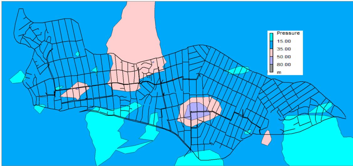
*Fig. V-2 Distribución de presiones con sectorización y control de presiones*
