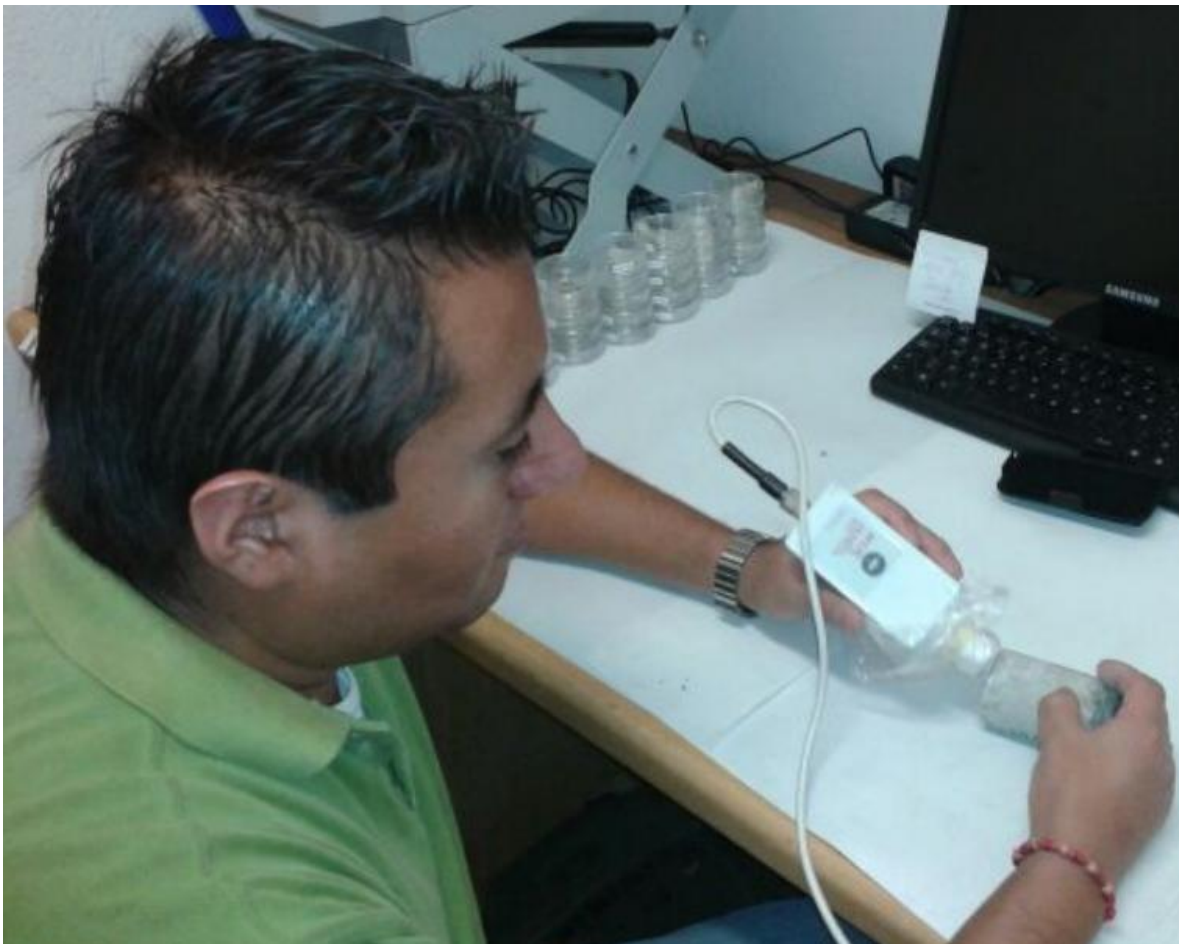
Fig. 5.1. Muestras de núcleos del pozo Peto, aplicándole el estudio de susceptibilidad magnética, mediante el equipo Bartington.
