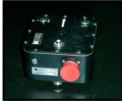
Fig. 23 Acelerómetro FBA-23 (Ref 51).
