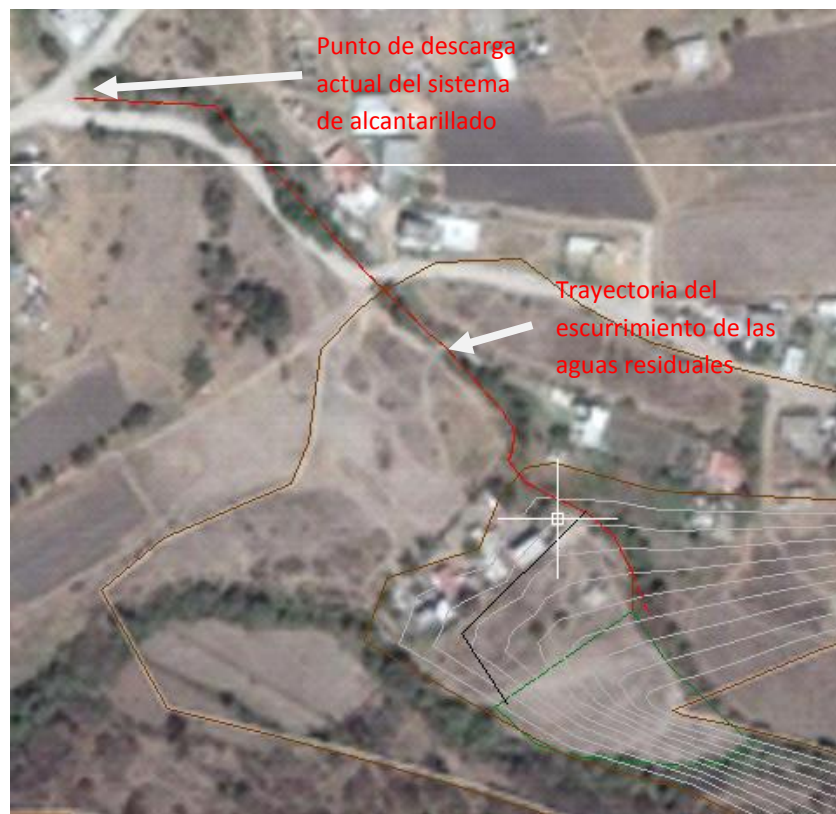
Figura 12.4.1. El terreno (polígono verde) tiene un área de 1822 m 2 . Las líneas cafés son las curvas de nivel más próximas al terreno (fuente: mapas INEGI versión 2015)
