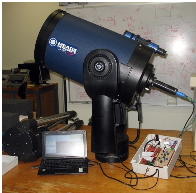
Figura 4.17. Sistema experimental de detección de señal del pulsar
