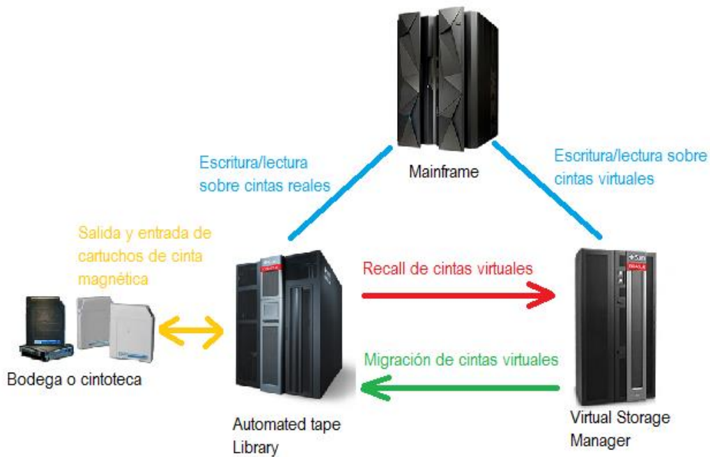
Esquema del sistema de almacenamiento virtual implementado en el CPD del cliente
