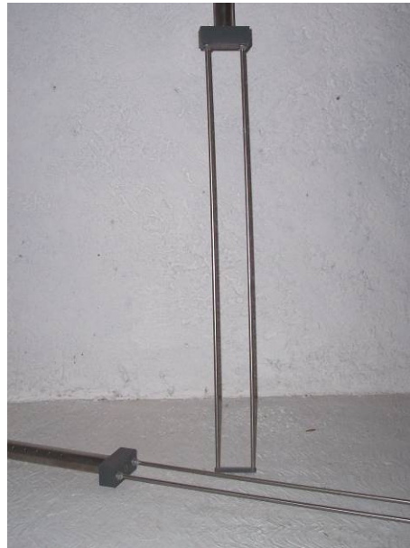
Figura V.5 Sensores de nivel
