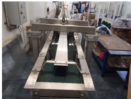
Figura 3. 2 Pala generadora de tipo pistón
