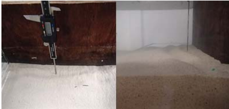
Figura 4. 17 Instrumento de medición de la socavación
