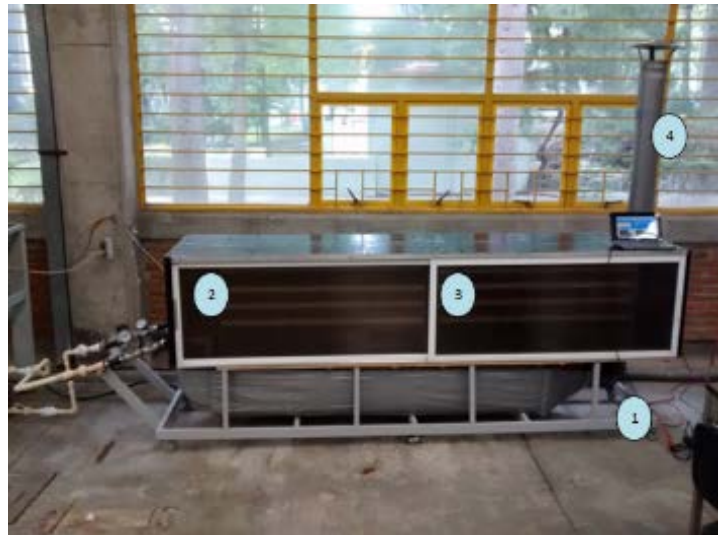
Figura 52 Deshidratador con posición física de los sensores RHT03. 1.-Entrada del aire del ambiente, 2.- Entrada en la cámara de deshidratado, 3.-A mitad de la cámara de deshidratado y 4.-Chimenea y salida de aire.
