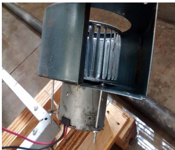
Figura 57 En la fotografía se muestra el motor extraído de un radiador automotriz acoplado con el impulsor y la coraza metálica que conforman el ventilador centrífugo.
