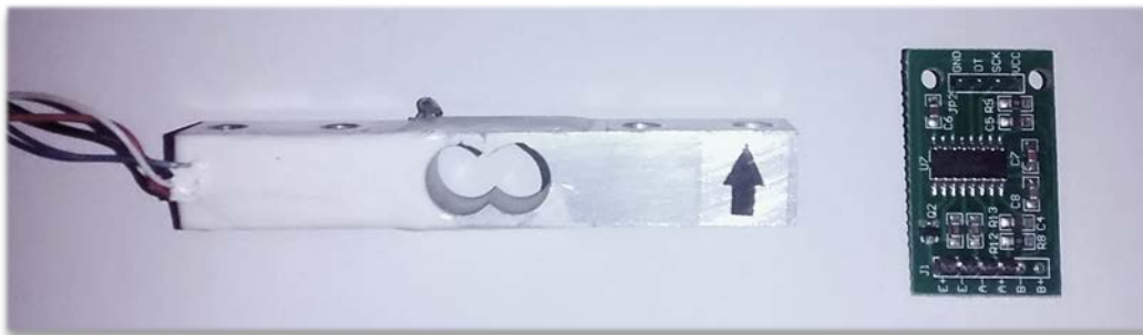
Figura 29 Fotografía de celda de carga de 20 kg y módulo HX711.
