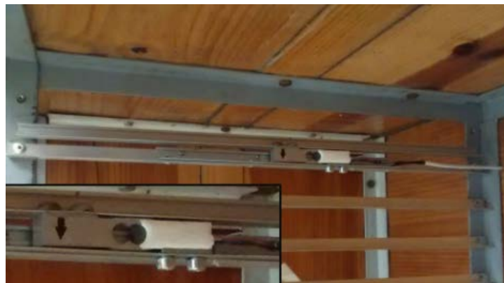
Figura 56 Celda de carga fijada dentro de la cámara de secado.
