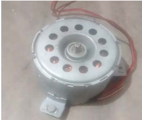
Figura 31 Motor extraído de un radiador automotriz que opera a 12v
