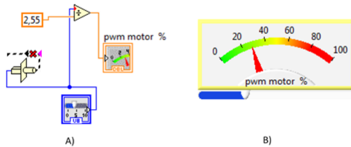
Figura 45 Toma de lectura de PWM. Figura A) muestra el diagrama a bloques y la figura B) el control e indicador que el usuario visualiza.
