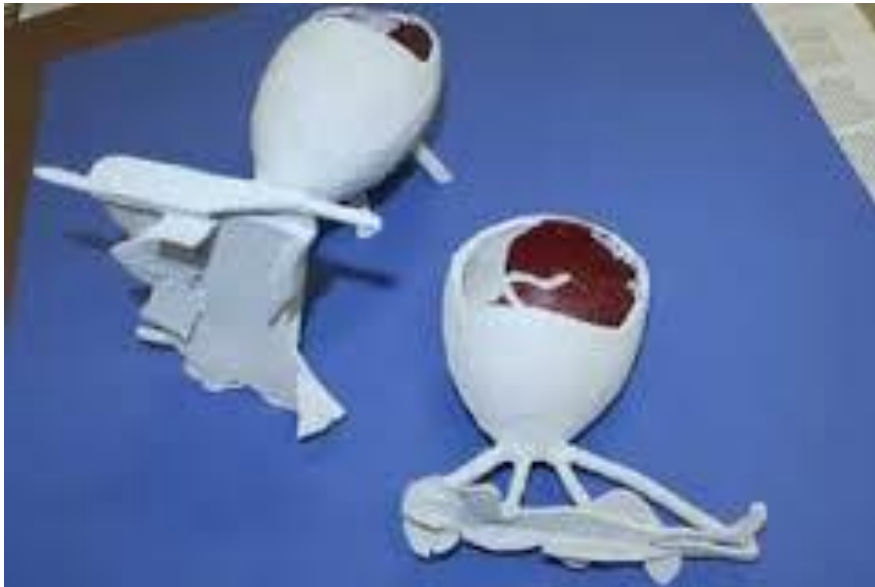
Figura 6. Imagen de piezas copiadas del modelo original con cáscara cerámica alrededor del modelo de cera. 5
