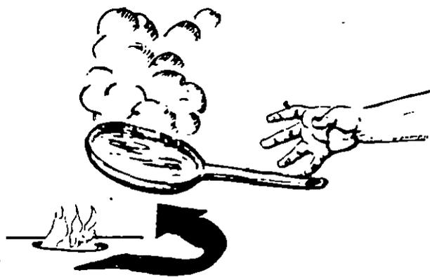
Figura 12 Transmisión de calor por conducción
