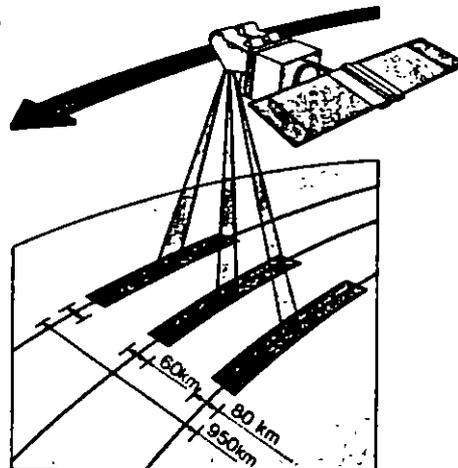
Figura 2.16 Cobertura de la mira vertical y oblicua del Spot (tomada de Spot image, 1989).
