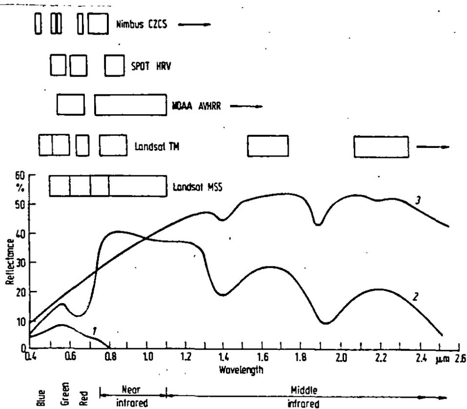
Figura 3.1 Firmas espectrales de tres materiales comunes de la superficie de la tierra. (1) Agua, (2) vegetación, (3) suelo. Posición de las bandas espectrales para los principales satélites de percepción remota (tomada de Richards, 1986).
