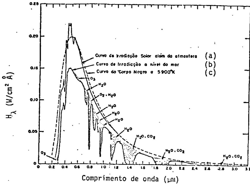
Figura 1.3 Espectros de irradiação. (a) irradiação solar na parte alta da atmosfera, (b) irradiação solar a nível do mar, (c) irradiação de um corpo negro a  $5900 \text{ }^\circ\text{K}$  (tomada de Steffen, et al 1981).
