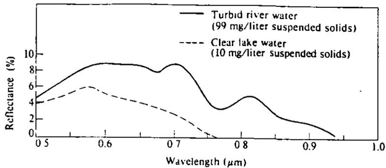
Figura 3.22 Reflectancia espectral del agua clara y agua turbia en el intervalo de 0.5 a 1.0  $\mu\text{m}$  (tomada de Bartolucci, et al 1977 en Hoffer, 1978).
