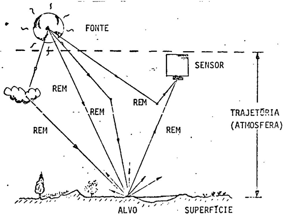
Figura 1.5 Elementos de un sistema de percepción remota.
