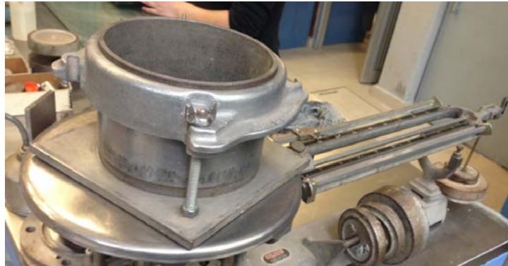
Figura 3.18. Molde usado para determinar pesos volumétricos
