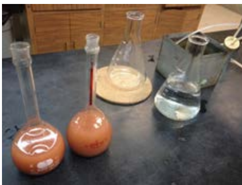
Figura 3.4. Determinación de densidad de sólidos, prueba en desarrollo
