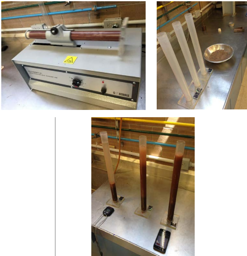
Figura 3.3. Prueba en desarrollo, equivalente de arena
