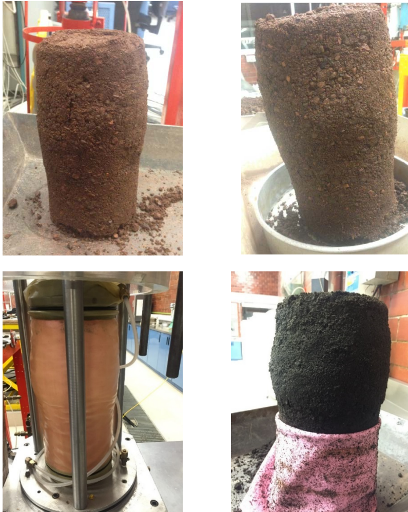
Figura 4.51. Ensanchamiento de la probeta
