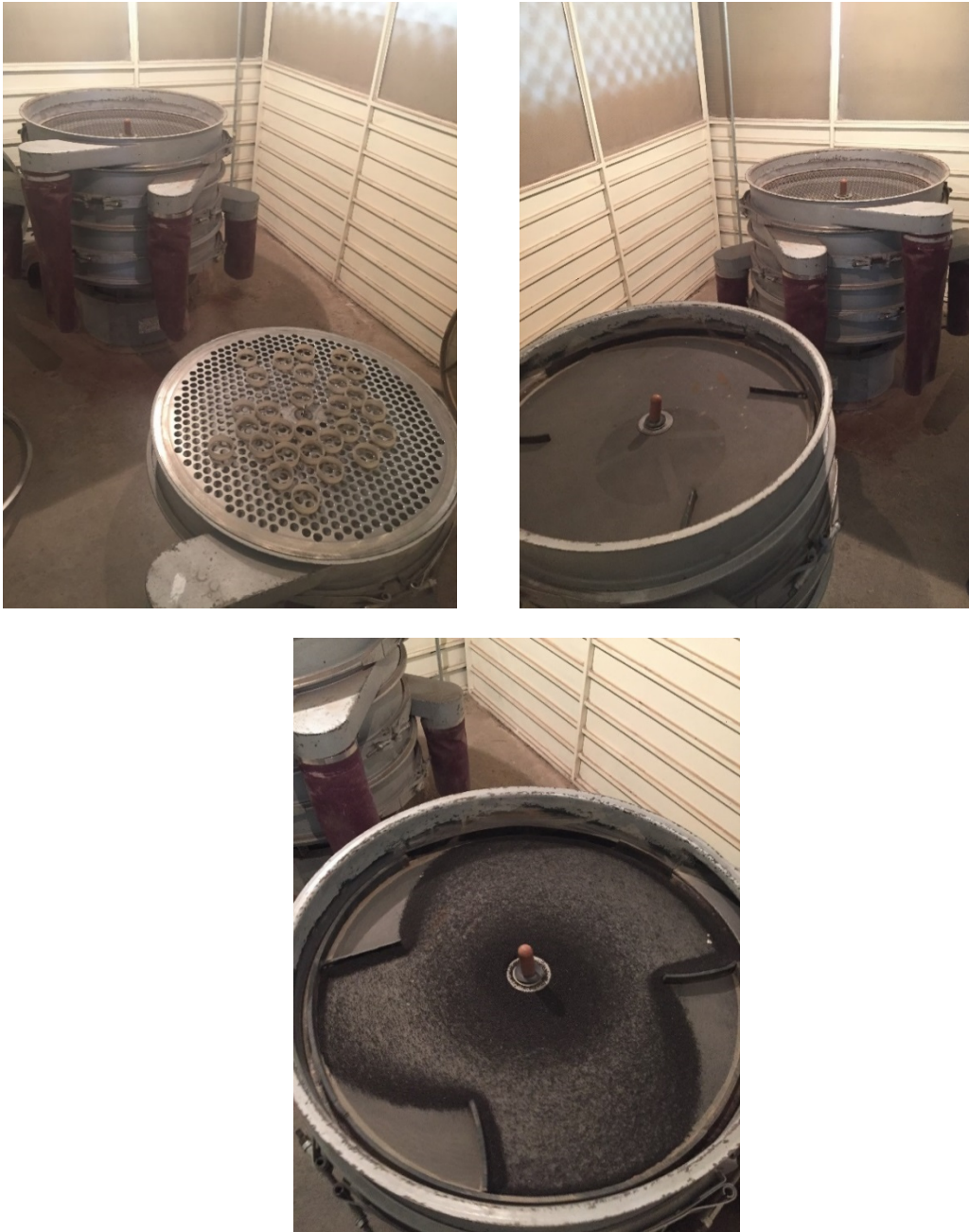
Figura 2.12. Cribadora de gran tamaño habilitada para este trabajo
