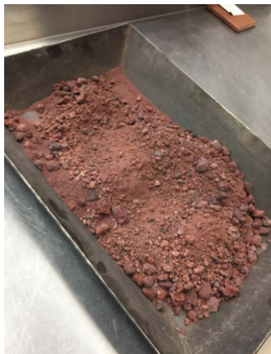
Figura 3.17. Homogenización del material
