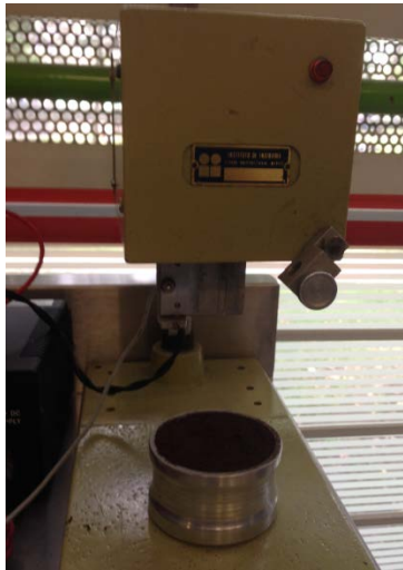
Figura 3.1. Límite líquido mediante Cono Sueco
