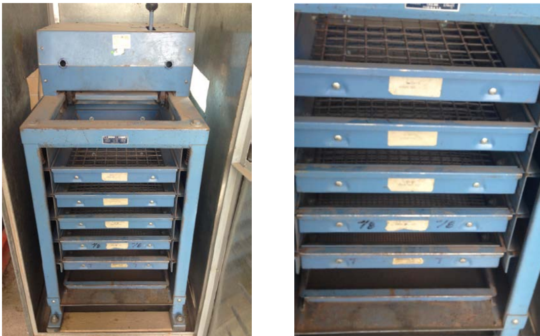
Figura 2.11. Cribadora de grandes dimensiones del Laboratorio de Vías Terrestres
