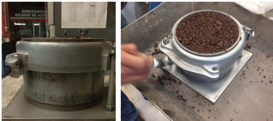
Figura 3.19. Molde con material enrazado
