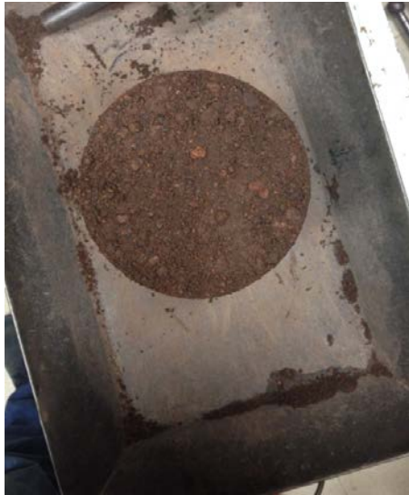
Figura 4.52. Probeta sin deformaciones radiales. Prueba C_r=95\% , \sigma_c=1.2 \text{ kg/cm}^2
