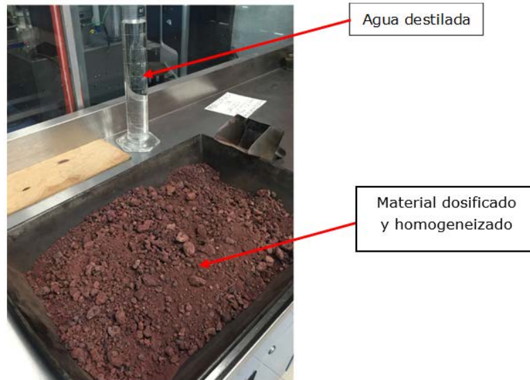
Figura 3.23. Preparación del material
