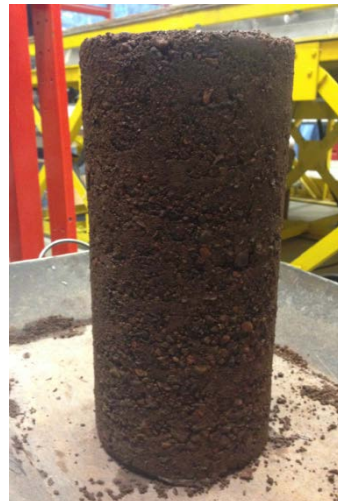
Figura 4.53. Entramado de partículas al ser compactadas
