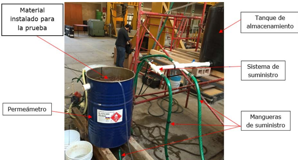
Figura 3.12. Sistema para pruebas de permeabilidad
