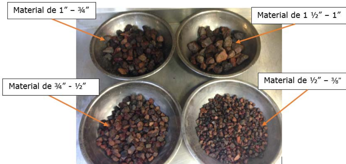
Figura 3.5. Material clasificado por tamaños según normativa
