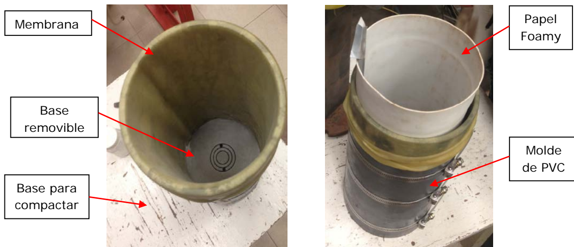
Figura 3.22. Molde para elaboración de probeta triaxial
