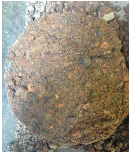
Figura 4.53. Entramado de partículas al ser compactadas
