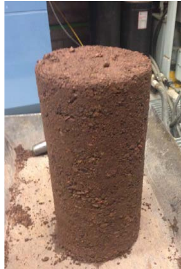
Figura 4.52. Probeta sin deformaciones radiales. Prueba C_r=95\% , \sigma_c=1.2 \text{ kg/cm}^2
