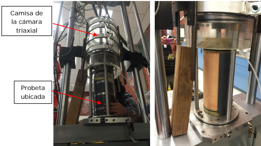
Figura 3.25. Instalación de la probeta en la cámara triaxial
