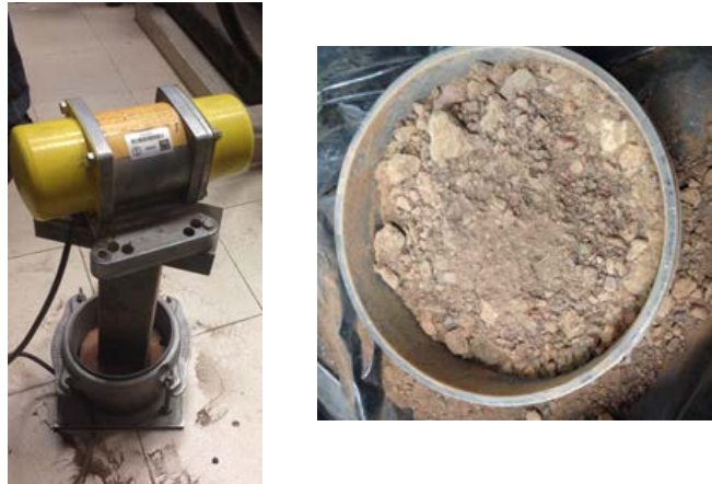
Figura 3.20. Vibrador usado y material compactado en el molde
