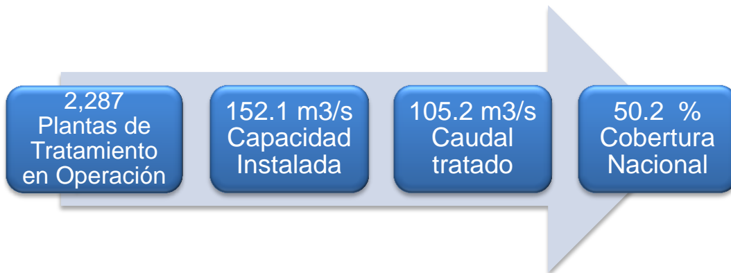
Figura 7. Infraestructura de saneamiento de aguas residuales municipales en México, 2013.
