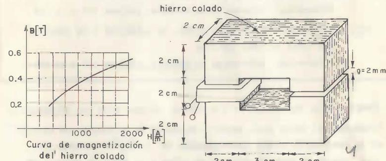
2. El núcleo toroidal de la figura está construido con dos materiales ferrimagnéticos distintos. Si el flujo magnético a través del material 2 es  $\phi_2 = 0.32 \text{ mWb}$  y con base en las curvas de magnetización, determinar:
