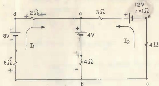
Aplicando el método de mallas,  $\Sigma V = 0$ , se obtiene:
