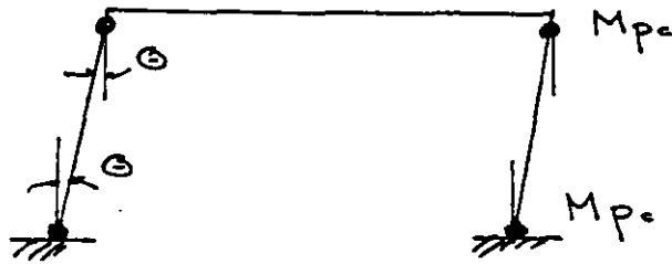
(b) Mecanismo de columnas
