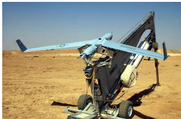
Figura 9. Lanzadera hidráulica de la empresa RPDEFENSE ® [6].
