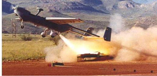
Figura 4. UAV con técnica de despegue RATO [5].
