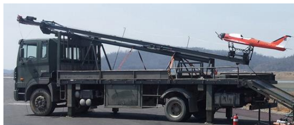
Figura 8. Lanzadera hidráulica de la empresa UAVRL ® [5].
