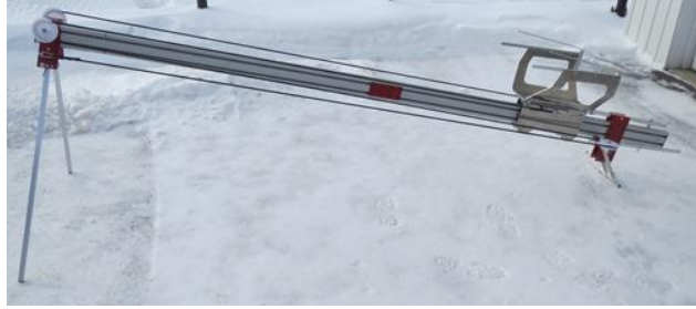
Figura 7. Lanzadera elástica modelo ASM300 de la empresa air visión ® [5].
