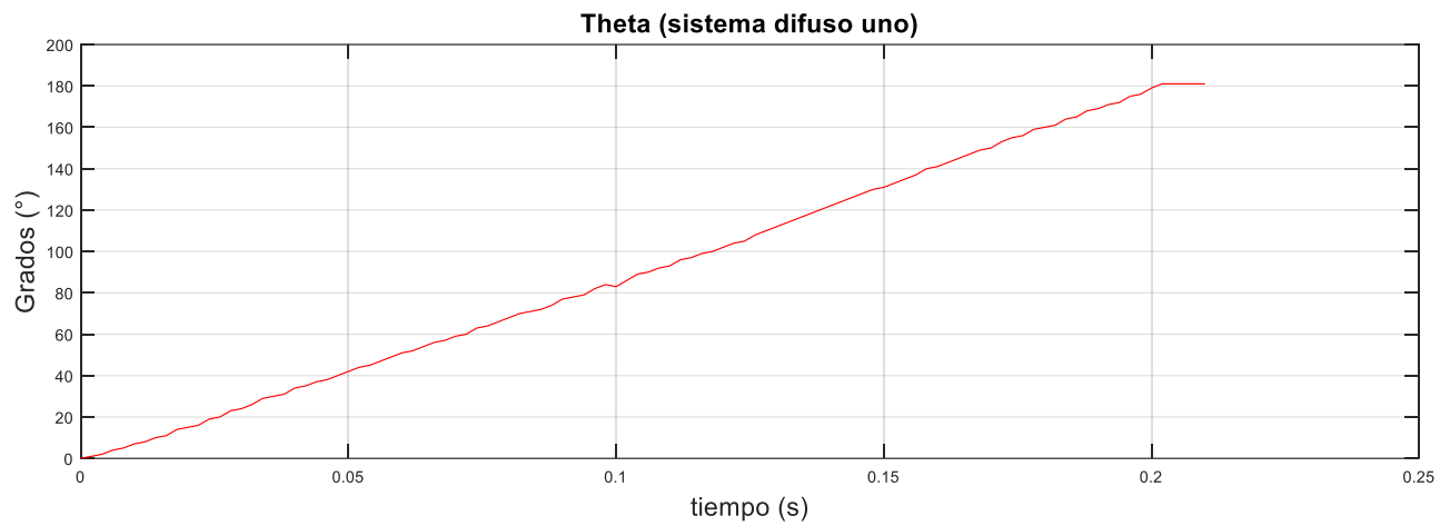
Figura 60. Resultado experimental para una entrada de 180° con el motor a 0°
