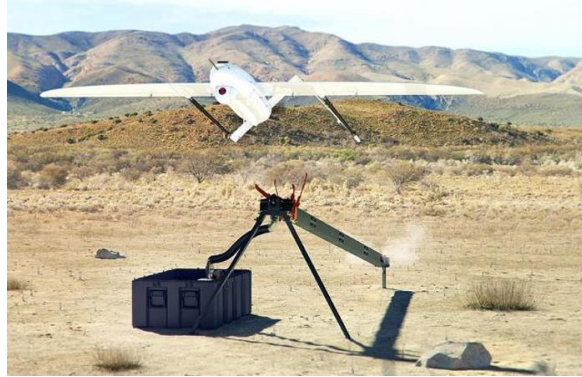
Figura 10. Lanzadera electromagnética modelo Penguin W ® [7].
