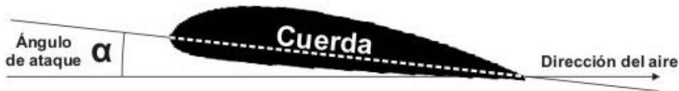
Figura 13. Ángulo de ataque referido a un tipo de perfil alar [48]
