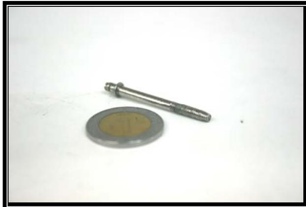
Figura 4-18 Flecha del motor de imán permanente.
