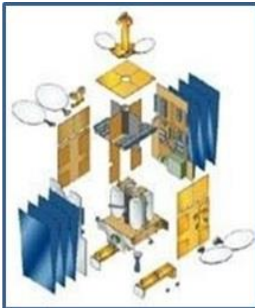
Fig. 3-8 Diseño modular de la plataforma E3000 Eurostar de Airbus Defense & Space; se observa una disposición similar a la plataforma SSL 1300.
