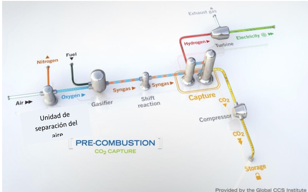
Figura 3.1 Sistema de Pre-Combustión, (Global CCS Institute, 2015).
