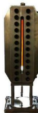
Figura 3.18 Dispositivo de la burbuja ascendente, (Instituto Mexicano del Petróleo, 2015)
