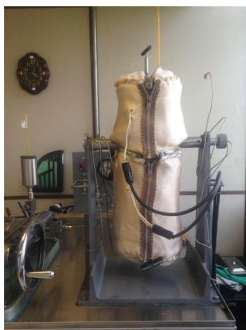
Figura 3.18 Dispositivo de la burbuja ascendente, (Instituto Mexicano del Petróleo, 2015)
