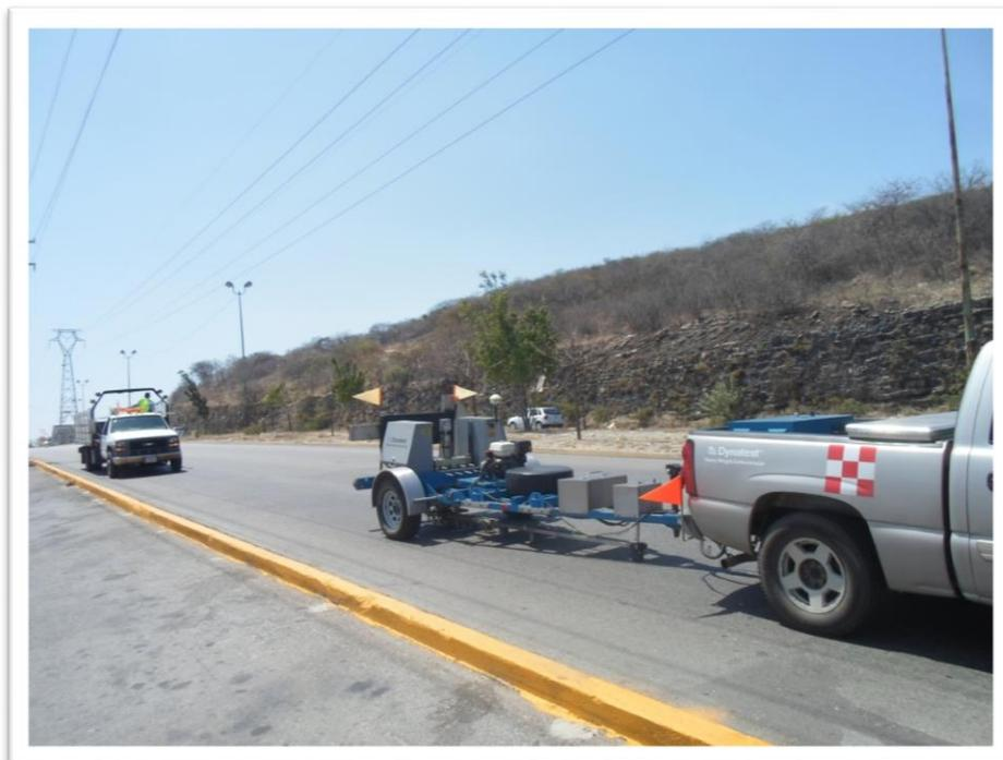
*Fotografía 3.2.1.2.- Medición de deflexiones con equipo HWD, km 4+200 cuerpo A.*
