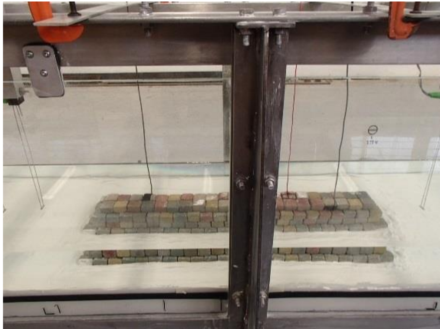
Figura IV. 18 Estructura, suelo en el canal de oleaje.
