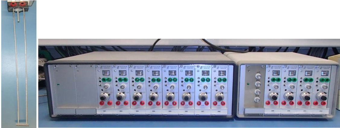
Figura IV. 4 Sensores de nivel.
