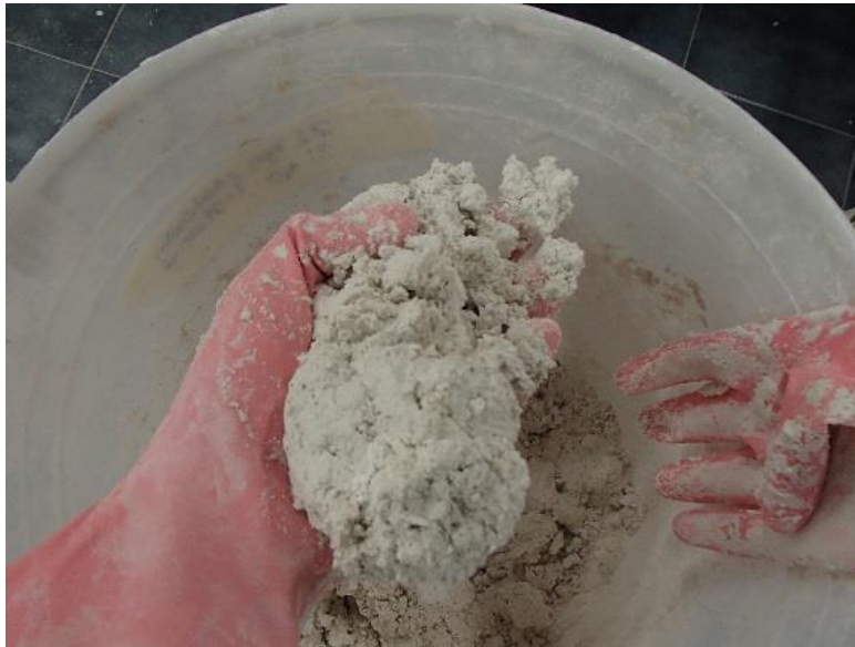
Figura IV. 16 Premezclado del caolín y agua.
