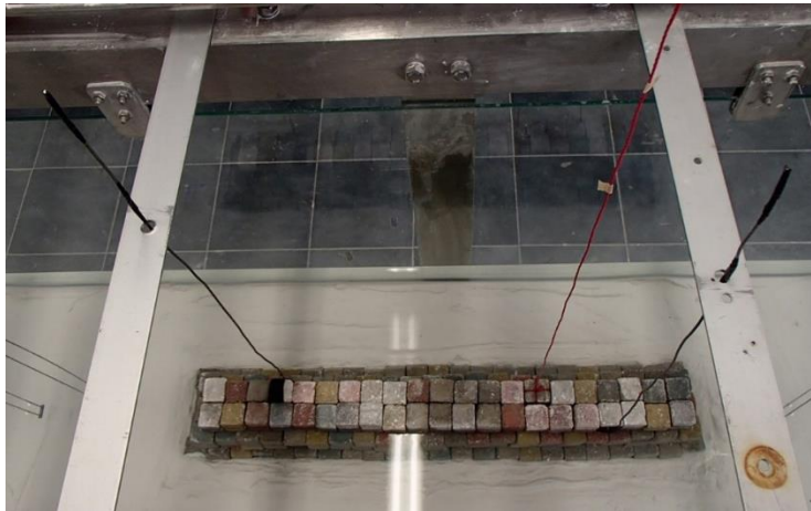
Figura V. 13 Medición del hundimiento, alambre-riel.
