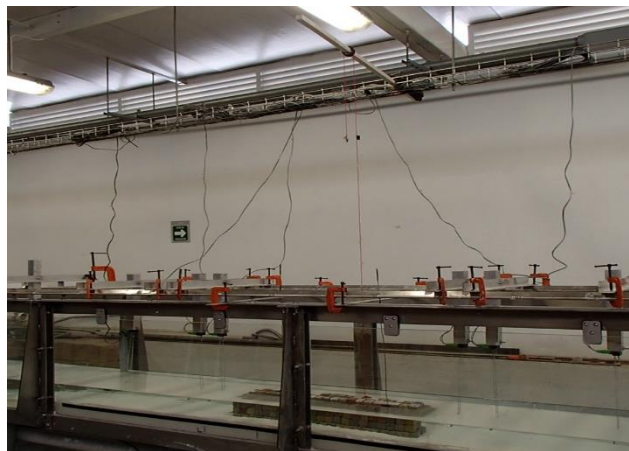
Figura V. 14 Medición del hundimiento, alambre-riel.
