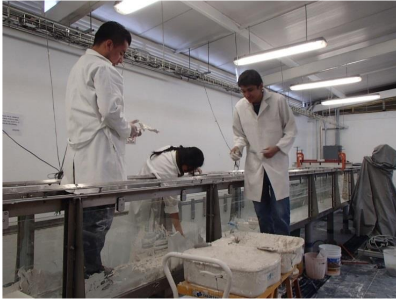
Figura IV. 21 Retiro del material y limpieza del canal.
