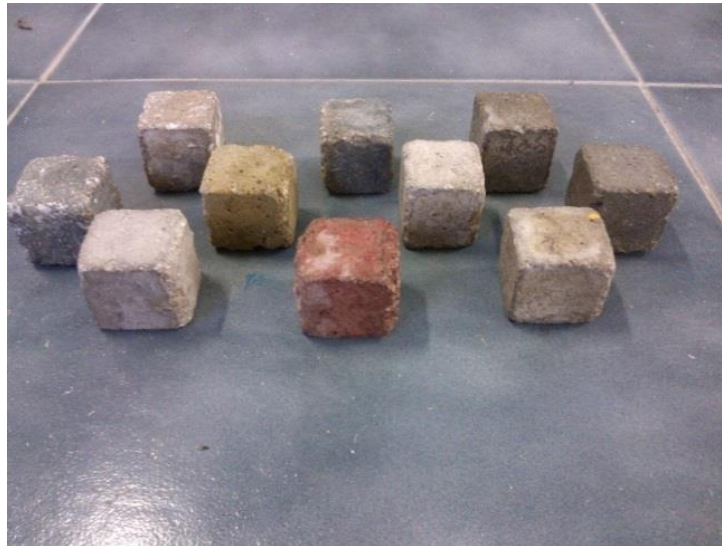
Figura IV. 14 Cubos de concreto.
