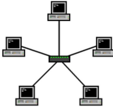
Fig. 1.13 Un Switch (conmutador) en el centro de una red es estrella.
