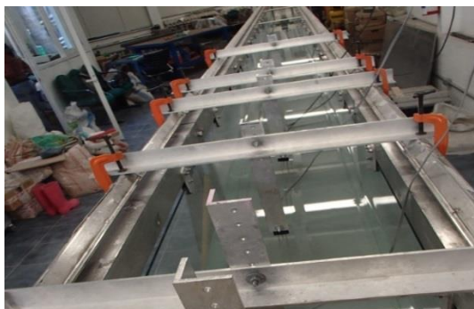
Figura 4.15 Colocación de los sensores de nivel
