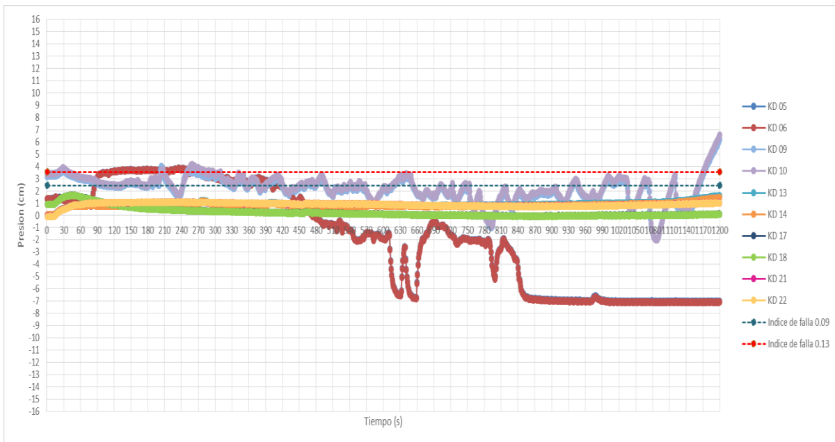
Figura 4.20 Gráfica de la serie de tiempo de los sensores, ensayo sin estructura de cubos, T=1.2 s
