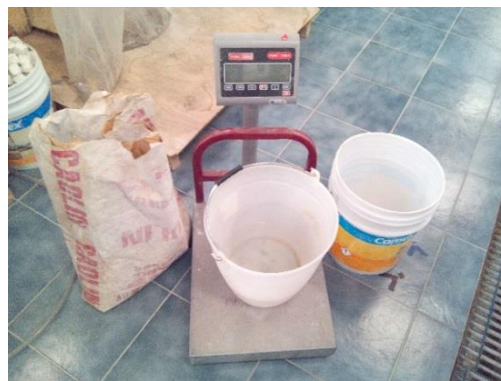
Figura 4.11 Dosificación de agua y caolín
