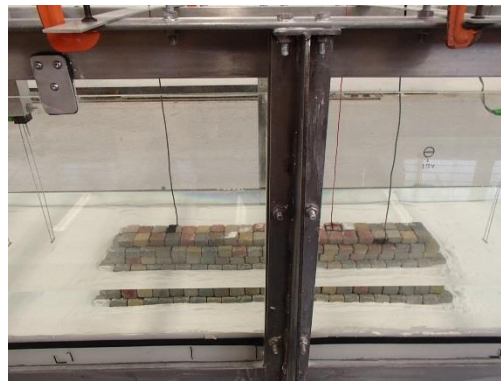
Figura 4.14 Estructura- suelo, en el canal de oleaje
