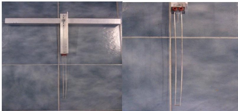
Figura 4.4 Sensores de nivel
