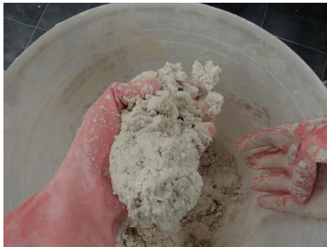
Figura 4.12 Premezclado del caolín y agua
