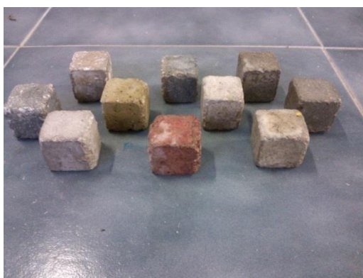
Figura 4.10 Cubos de concreto
