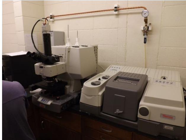
Figura 13. Espectroscopio Thermo Electron Nicolet 6670 FTI
