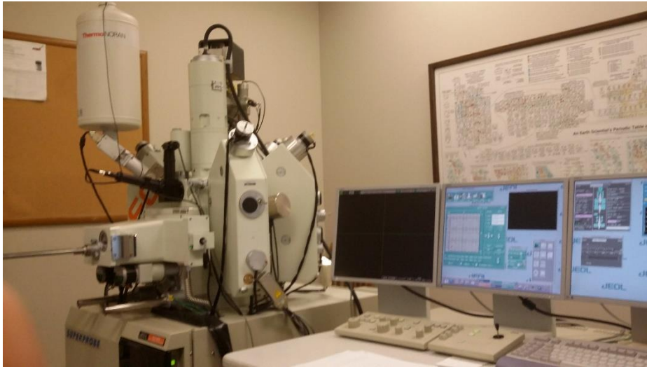
Figura 11. Fotografía de la Microsonda Electrónica JEOL JX-8600
