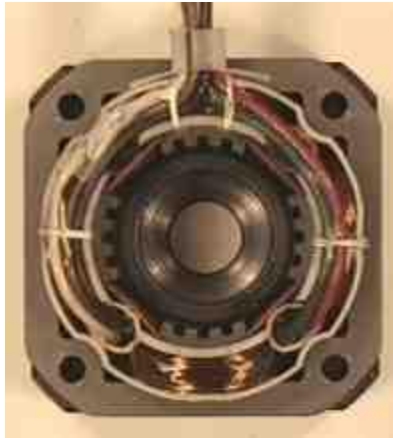
Figura 3.4.9 Imagen de un estator de 4 bobinas
