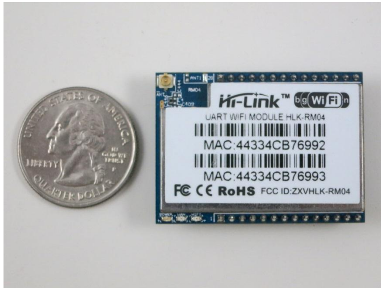
Figura 4.1.10 Módulo HLK-RM04, comparación de tamaño
