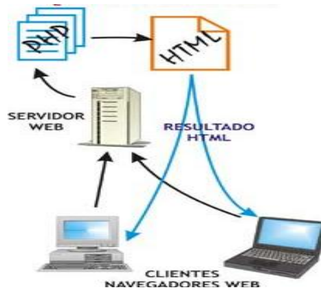
Figura 2.6.1 Secuencia de Ejecución de PHP
