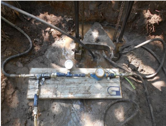
Fotografía 51 y 52. Saturación del barreno durante 1 hora, antes de realizar cada prueba de permeabilidad Lefranc.
