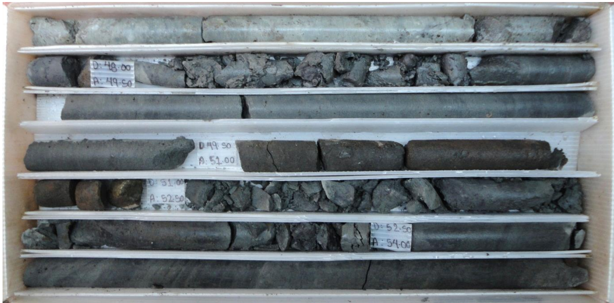
Fotografía 42. Recuperación del S-14 de 48.80 a 54.80 m, De 47.50 a 55.50 m arenisca de grano medio color gris claro, densidad baja a media, presenta textura clástica de grano medio ligeramente compacta y poco fracturada.
