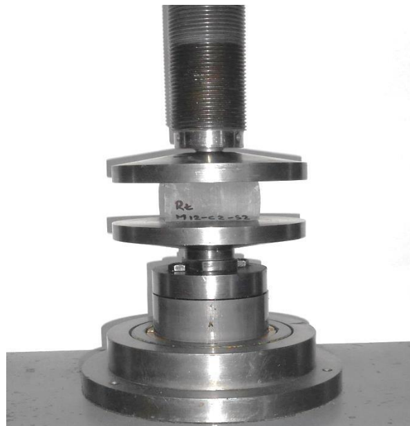
Fotografía 50. Núcleo de roca durante el ensaye de tensión indirecta (prueba brasileña).
