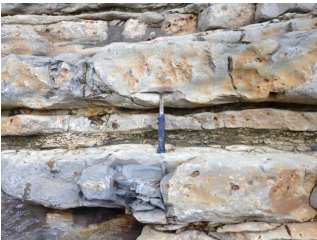
Fotografía 15. Caliza tipo mudstone, textura micrítica color gris claro. Presenta ligera carsticidad, densidad media alta y su estratificación es media, del orden de 40 cm, pertenece a la base de la Formación Soyaló.
