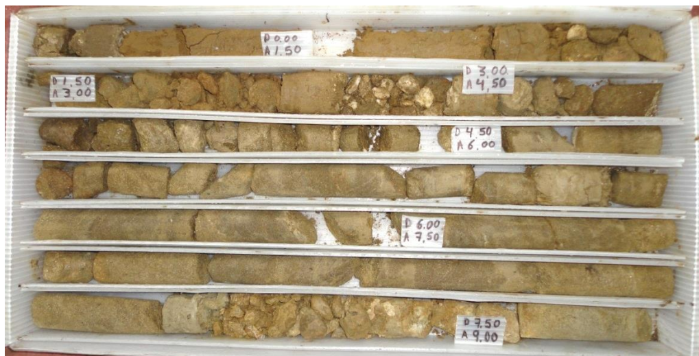
Fotografía 40. Recuperación del S-12 de 0.00 a 9.20 m. De 0.00 a 4.50 m depósito del abanico aluvial. De 4.50 a 8.50 m arenisca color pardo con tonos blancos, los granos son de feldespatos, mica blanca y cuarzo principalmente, con horizontes arcillosos de la Formación El Bosque.
