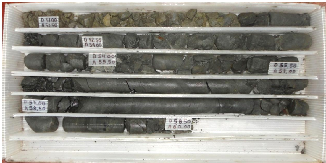
Fotografía 38. Recuperación del S-7 de 52.45 a 60.00 m, arenisca de grano fino y lutita de la Formación Soyaló.
