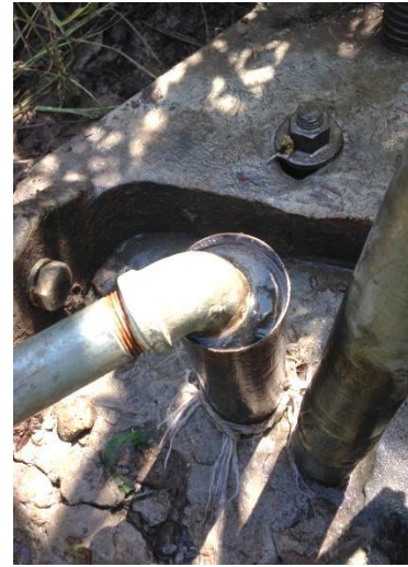
Fotografía 53 y 54. Prueba Lefranc constante. Detalle durante la prueba de permeabilidad en el barreno S-4 tramo de 5.00 a 10.00 m de profundidad y sobre el km 0+847, del túnel 1, proyecto P.H. Río Frío. San Lucas, Chis.
