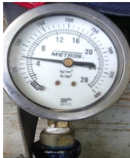
Fotografía 57 a 61. Prueba Lugeon. Detalle durante la prueba de permeabilidad en el barreno S-10 tramo de 10.00 a 15.00 m de profundidad en el 1+334 km del Túnel 3. Nótese el equipo utilizado, así como las unidades de presión en \text{kg}/\text{cm}^2 .
