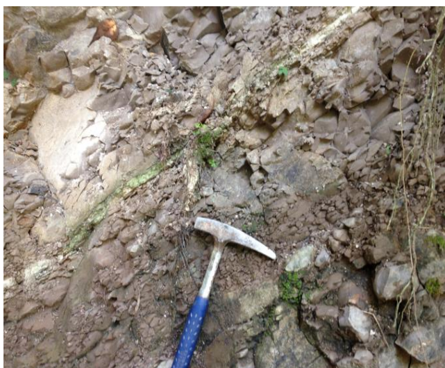
Fotografía 12 y 13. Vista de un afloramiento en la margen derecha aguas arriba a escasos 50 m del eje de cortina de la obra de toma. Nótese el fracturamiento y alteración superficial de areniscas, así como de una alternancia con lutitas.
