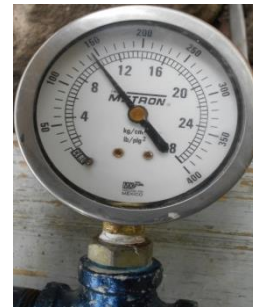
Fotografía 57 a 61. Prueba Lugeon. Detalle durante la prueba de permeabilidad en el barreno S-10 tramo de 10.00 a 15.00 m de profundidad en el 1+334 km del Túnel 3. Nótese el equipo utilizado, así como las unidades de presión en \text{kg}/\text{cm}^2 .
