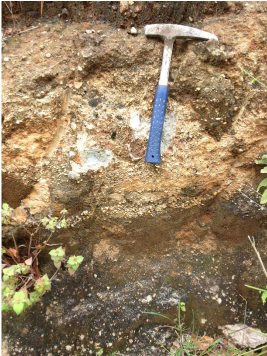
Fotografía 4. Depósito aluvial, en donde los bloques son de composición diorítica y andesítica, y la matriz es un material arenoso con finos. El afloramiento corresponde a la parte distal de un abanico aluvial tipo flujo de escombros (Debris flow), y pertenece a uno de los depósitos más recientes. Nótese la gradación normal.
