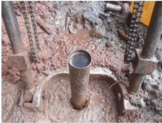
Fotografía 55 y 56. Prueba Lefranc variable. Detalle durante la prueba de permeabilidad en el barreno S-5 tramo de 5.00 a 10.00 m de profundidad en el 0+225km del Túnel 2.
