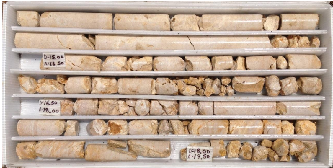
Fotografía 36. Recuperación del S-2 de 15.00 a 19.75 m, dichos núcleos representan el depósito de talud constituido por fragmentos de caliza en una matriz limo-arcillosa con arenas.
