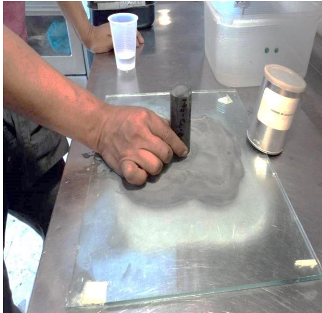
Fotografía 47. Pulido de caras en núcleos de roca de los barrenos S-OT2 y S-OT3.
