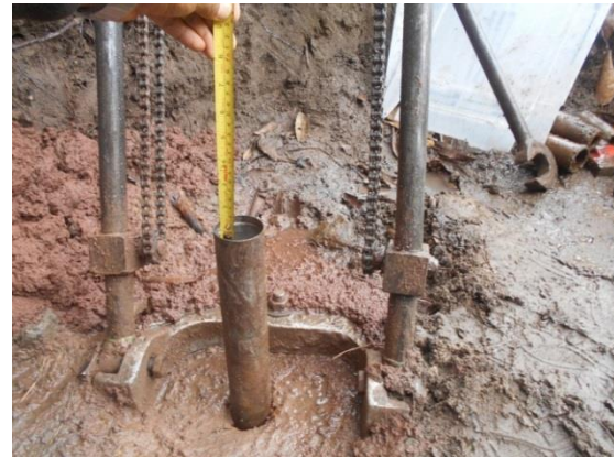
Fotografía 55 y 56. Prueba Lefranc variable. Detalle durante la prueba de permeabilidad en el barreno S-5 tramo de 5.00 a 10.00 m de profundidad en el 0+225km del Túnel 2.
