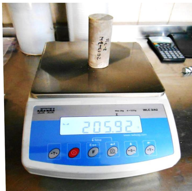
Fotografía 48. Determinación del peso de cilindros de roca.
