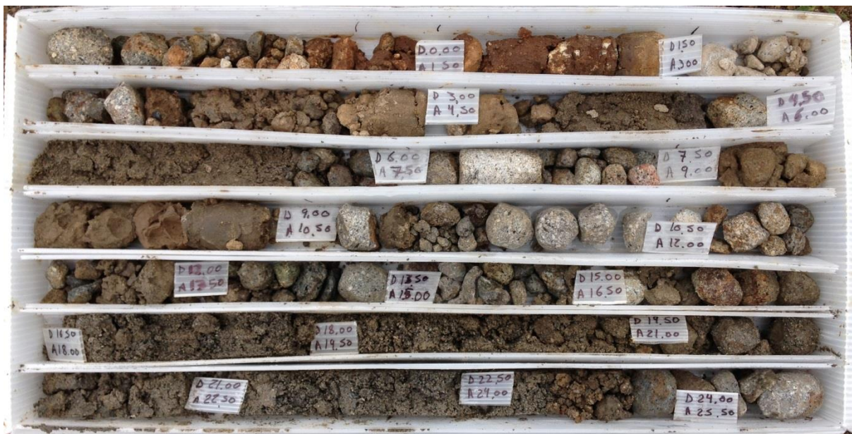
Fotografía 37. Recuperación del S-4 de 0.00 a 25.55 m, dicho material representa el material aluvial caracterizado por fragmentos de diorita en una matriz arenosa con limo y arcilla.
