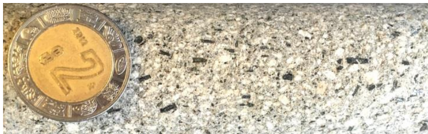
Fotografía 3. Diorita, roca intrusiva, textura fanerítica de composición feldespática (presumible plagioclasas>feldespatos) y anfíboles, con escaso cuarzo.
