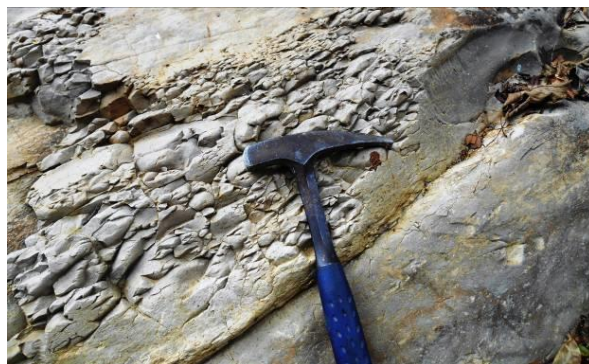
Fotografía 10 y 11. Arenisca calcárea fracturada en la zona del proyecto. Estratificación y meteorización superficial.
