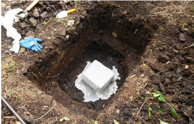
Fotografía 34. Proceso de protección con manta de cielo y cera-parafina de la muestra cúbica del PCA-OT1 preparada para su transporte al laboratorio.
