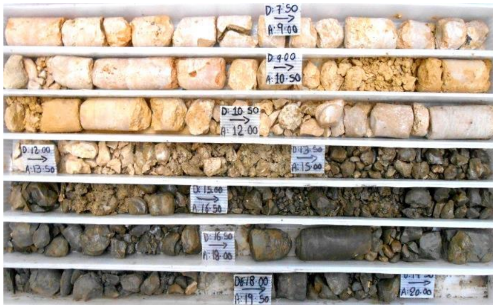
Fotografía 32. Muestra de los núcleos de roca del S-OT1 de la zona de obra de toma. En donde se observa que el depósito de talud integrado por fragmentos de caliza puede alcanzar hasta los 15 m de profundidad, a partir de dicha profundidad existe una arenisca calcárea de la Formación Soyaló, la cual puede estar intensamente fracturada.
