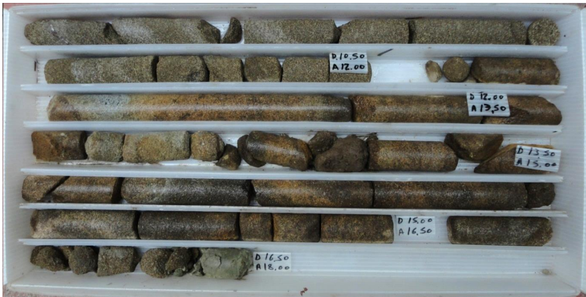
Fotografía 43. Recuperación del S-15 de 10.50 a 18.00 m, de 6.00 a 12.00 m arenisca cementada por carbonatos, textura clástica de grano medio a grueso color pardo claro con tonos cremas, con un ángulo de estratificación cercano a los 50° aproximadamente. De 12.00 a 17.50 m arenisca de textura clástica de grano grueso con finas gravas (pedernal en su mayoría), color pardo claro con tonos rojizos a marrón, bien compacta. Las fracturas tienen relleno arcilloso color rojizo a crema.
