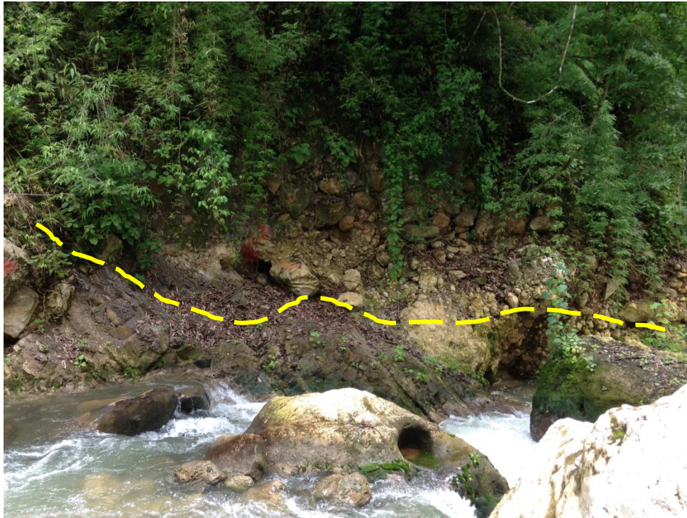
Fotografía 14. Vista de la margen izquierda mostrando el contacto entre las areniscas y el depósito de talud.
