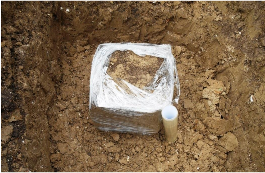
Fotografía 35. Muestra cúbica labrada en el PCA-LC1 sobre el eje de conducción de río Frío a los 90 cm de profundidad debido a que la dureza del terreno, alcanza un horizonte arcilloso-arenoso muy compacto.
