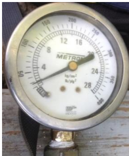
Fotografía 57 a 61. Prueba Lugeon. Detalle durante la prueba de permeabilidad en el barreno S-10 tramo de 10.00 a 15.00 m de profundidad en el 1+334 km del Túnel 3. Nótese el equipo utilizado, así como las unidades de presión en \text{kg}/\text{cm}^2 .
