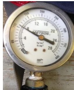
Fotografía 57 a 61. Prueba Lugeon. Detalle durante la prueba de permeabilidad en el barreno S-10 tramo de 10.00 a 15.00 m de profundidad en el 1+334 km del Túnel 3. Nótese el equipo utilizado, así como las unidades de presión en \text{kg}/\text{cm}^2 .
