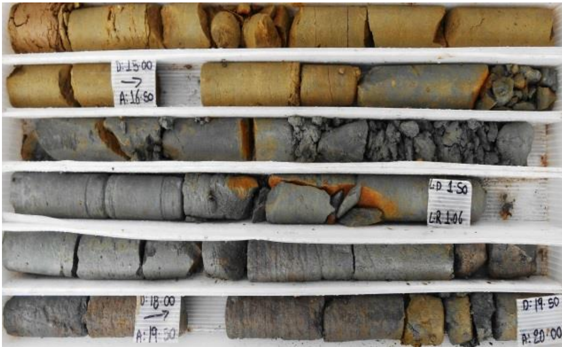
Fotografía 44. En el sondeo S-CM3, la arenisca se encontró a 17 m en la zona donde se contempla el desplante de la turbina tipo Pelton.
