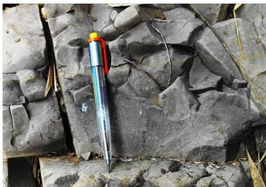
Fotografía 10 y 11. Arenisca calcárea fracturada en la zona del proyecto. Estratificación y meteorización superficial.
