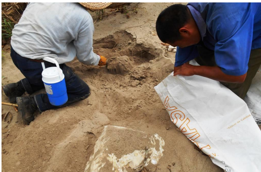
Fotografía 31. Muestreo de arena en la margen derecha del río dentro de la zona del banco de materiales 2.
