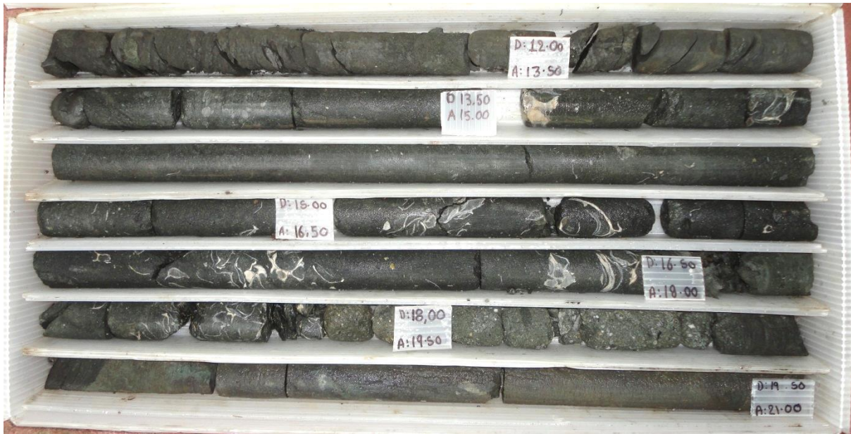
Fotografía 41. Recuperación del S-10 de 13.10 a 21.00 m, De 12.00 a 15.00 m
