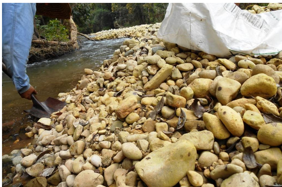
Fotografía 28. Detalle de la recolección de gravas de composición calcárea en la zona del banco de material 1 (BM-1) sobre la margen derecha de río Frío.
