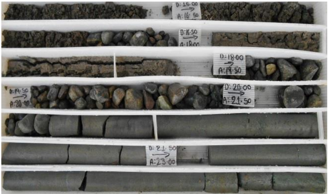
Fotografía 45. En el sonde S-CM2, la arenisca se encontró a 20 m de profundidad en la zona donde se contempla el desplante de la turbina tipo Francis.
