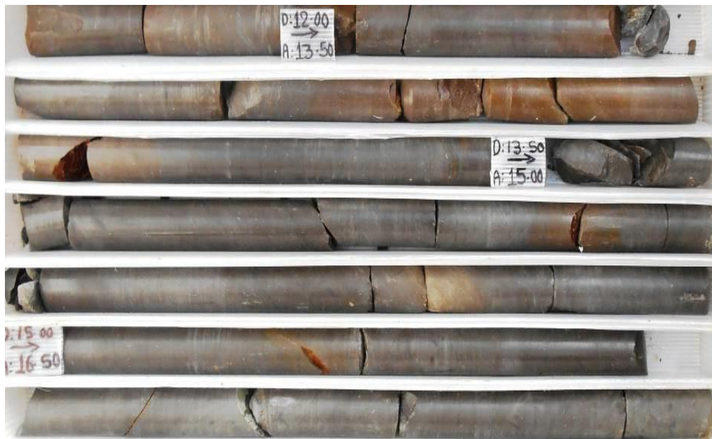
Fotografía 33. Muestra de los núcleos del S-OT2 de la zona de Obra de Toma, en donde la arenisca se encuentra ligeramente fracturada, con un RQD promedio de 47%.
