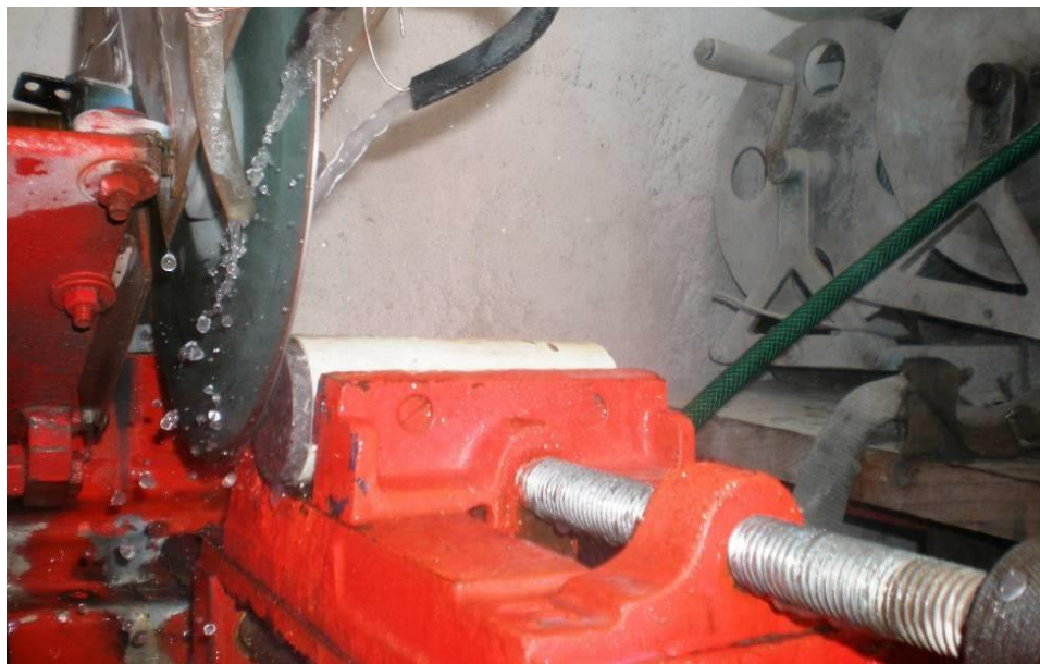
Fotografía 46. Corte y preparación de núcleos de roca procedentes de los barrenos S-OT2, y S-OT3 perforados aguas arriba del eje de cortina de la obra de toma.
