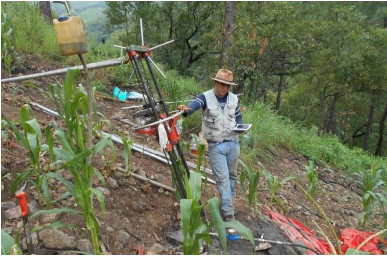
Fotografía 53 y 54. Prueba Lefranc constante. Detalle durante la prueba de permeabilidad en el barreno S-4 tramo de 5.00 a 10.00 m de profundidad y sobre el km 0+847, del túnel 1, proyecto P.H. Río Frío. San Lucas, Chis.
