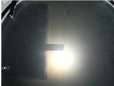
Figura 48. Orientación de la cánula proyectada en el sistema de referencia del proyector de perfiles NIKON Profile Projector V-16D
