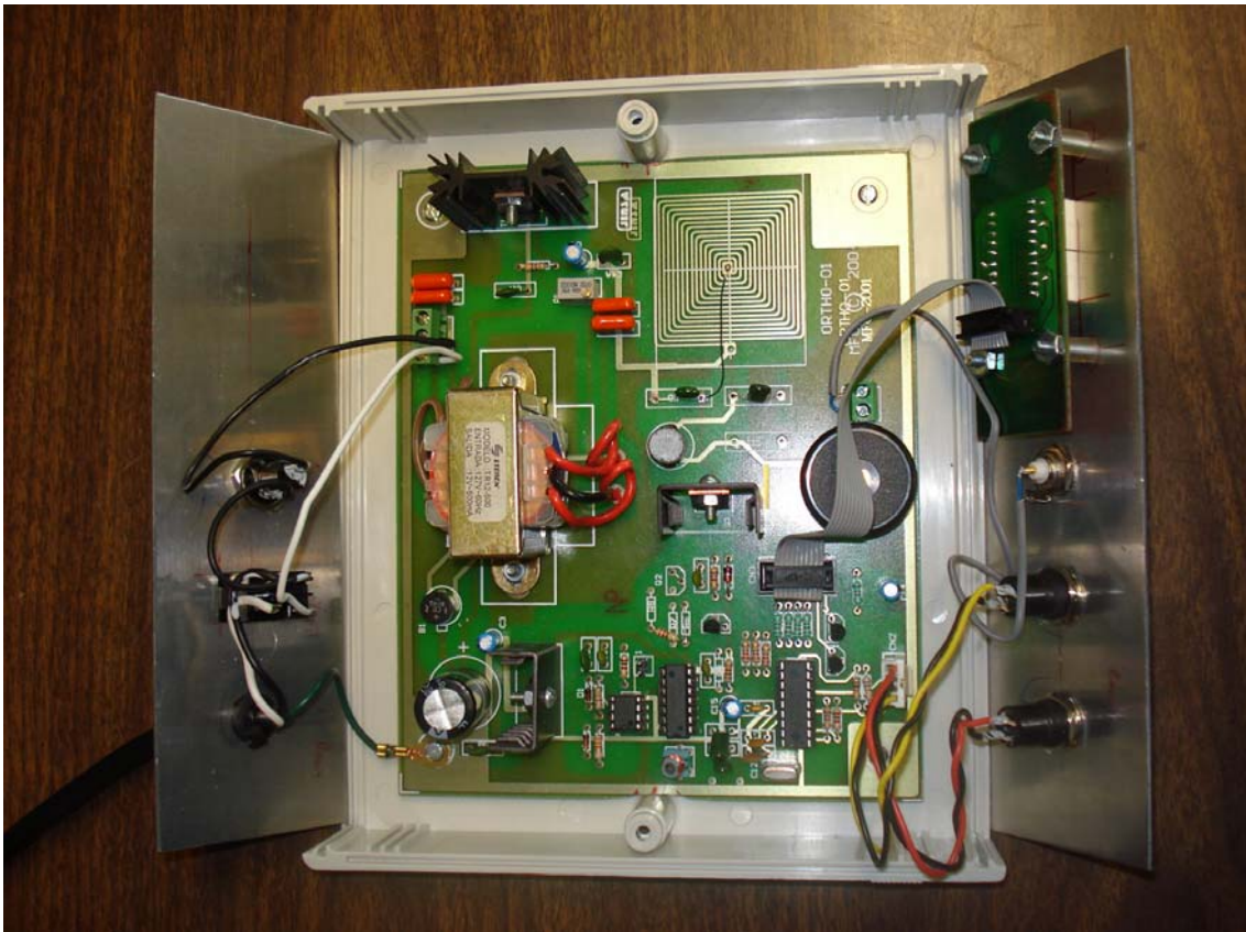
Figura 4.25. Construcción del equipo de terapia ultrasónica.
